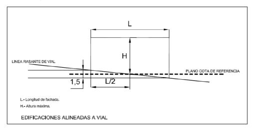
Si el desnivel entre los dos extremos de la línea de fachada es igual o menor a 1,50 m la altura se contabilizará a partir punto media de la fachada alineada a vial.
