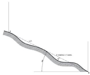
Si la pendiente del terreno no es uniforme, la línea de pendiente (L.P.) será una quebrada que cumplirá en cada tramo la condición d  $\leq$ = 1 m.
