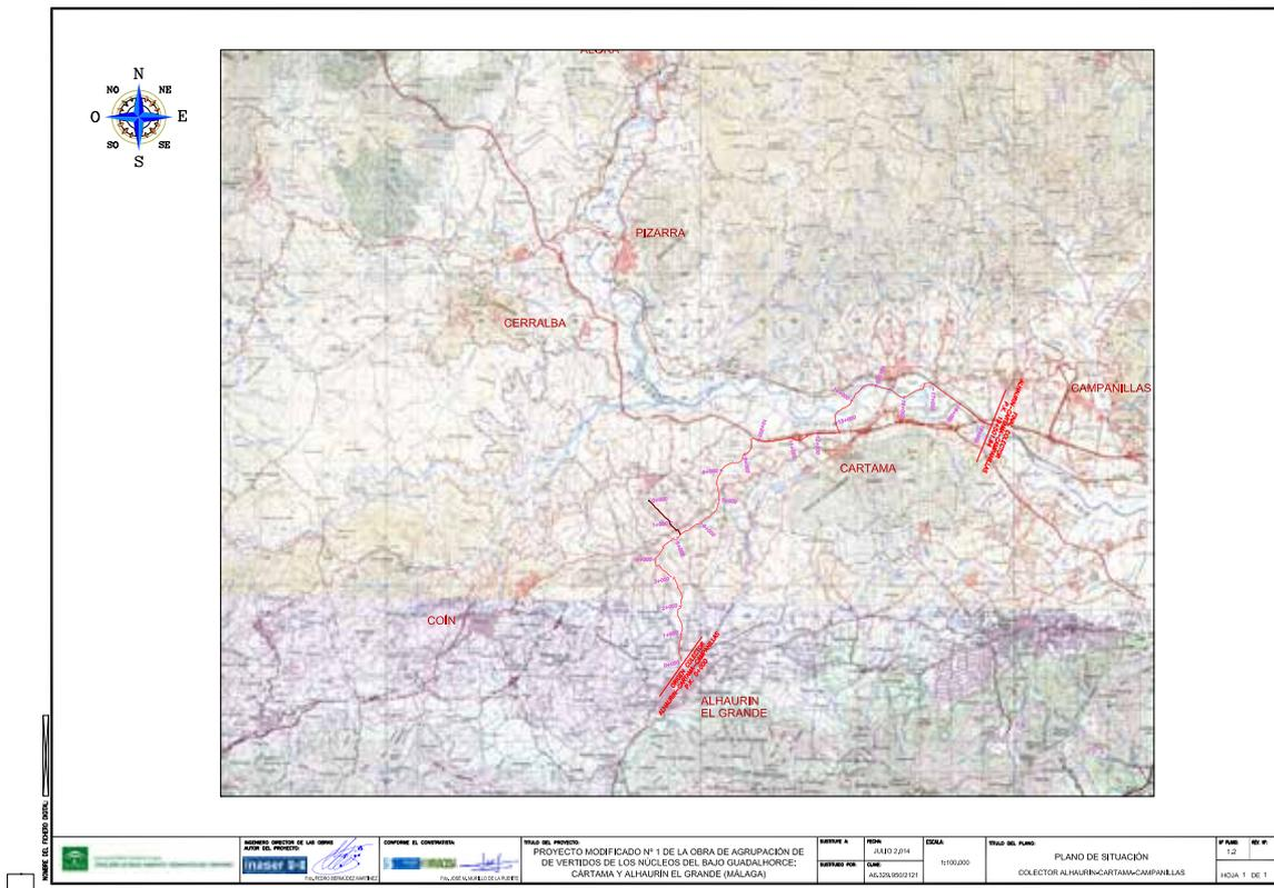
El colector inicia su trazado al norte del núcleo de Alhaurín el Grande transcurriendo paralelo por el «arroyo de la Villa» hasta que éste incorpora sus aguas al «río Fahala» que cruza el colector para, posteriormente, transcurrir paralelo al mismo hasta que sus aguas se incorporan al río Guadalhorce que cruza el colector para transcurrir paralelo al mismo, al norte de la población de Cártama, hasta el límite del término municipal de Cártama con Málaga donde concluye el colector.
