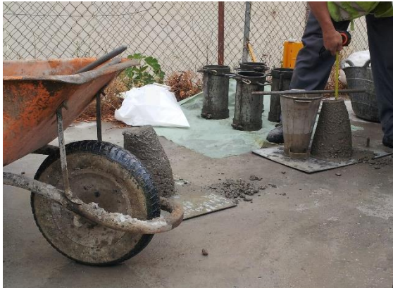
Imagen 4. Ensayo de asentamiento mediante Cono de Abrams.
