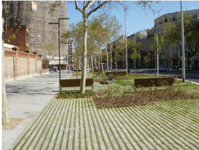
SUPERFICIES POROSAS, PAVIMENTOS PERMEABLES, PAVIMENTOS POROSOS, SUPERFICIES O SUELOS DRENANTES
