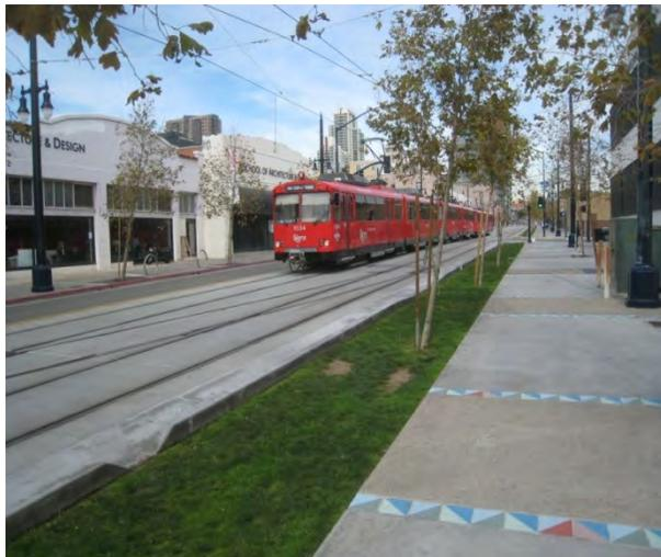
Esta técnica, con presencia de vegetación, favorece la sedimentación de las partículas y contaminantes arrastrados por el agua, así como la infiltración del agua y la disminución de la escorrentía. La presencia de vegetación favorece determinados mecanismos de reducción de contaminantes.
