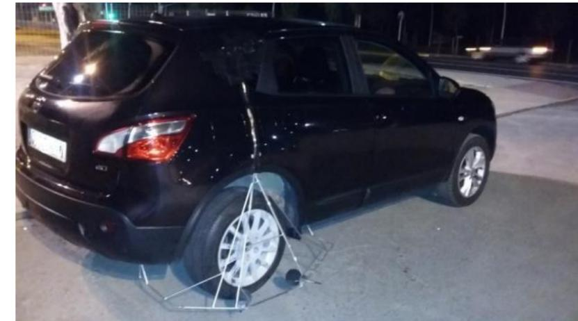
Figura 8. Sistema de medida CPX utilizado por la Fundación CIDAUT
