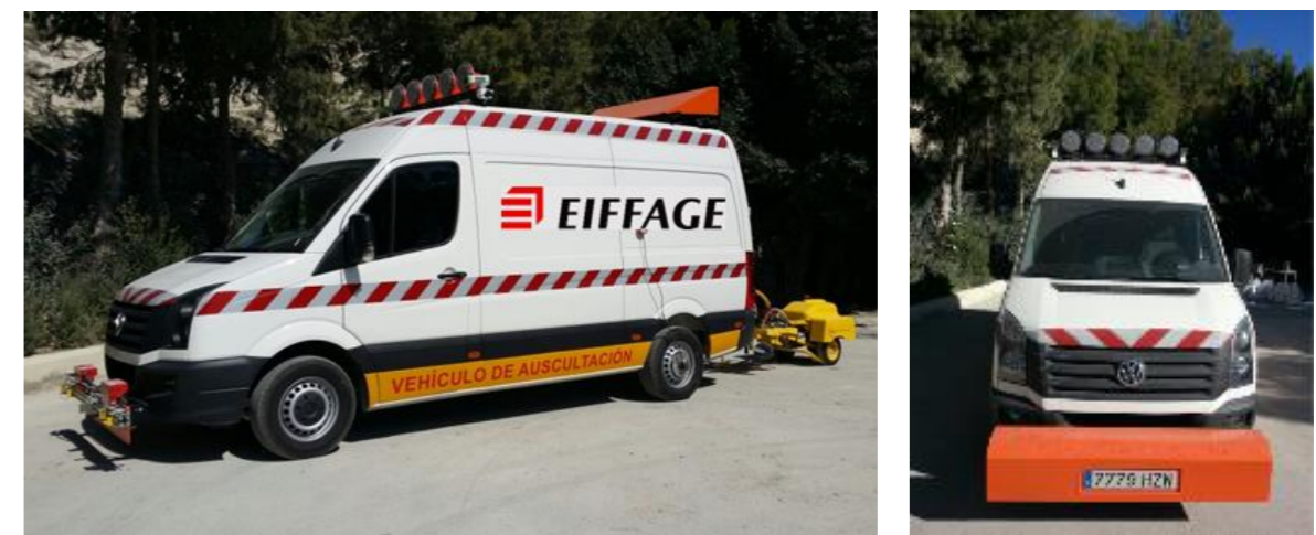
Figura 21. Vehículo de auscultación, Eiffage Infraestructuras
