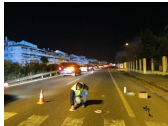
Figura 20. Mediciones del círculo de arena en A-8058 (sentido Coria)
