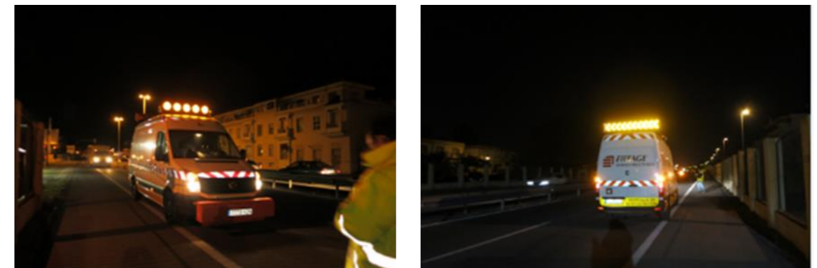
Figura 24. Vehículo de auscultación: Medición IRI
