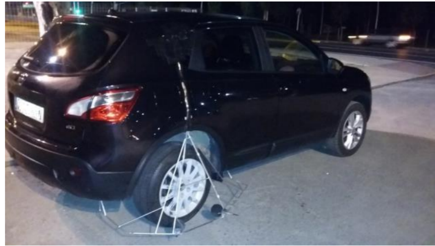
Figura 11. Sistema de medida CPX utilizado por la Fundación CIDAUT
