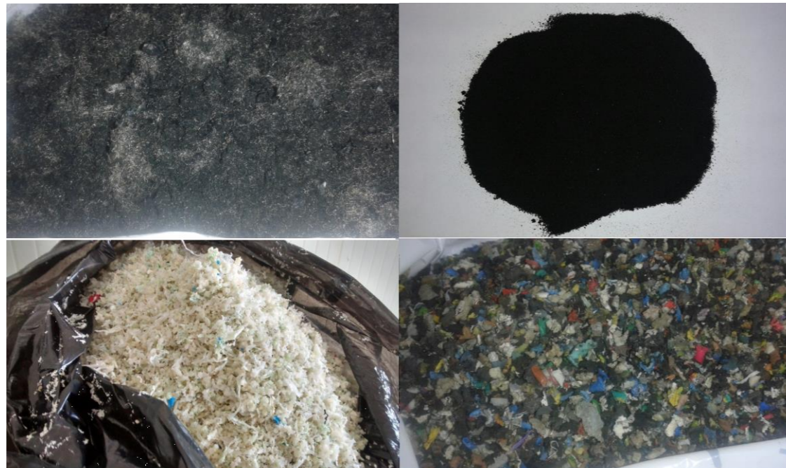
Figura 26. 1 (Nylon), 2 (Polvo de NFU), 3 (Plástico de invernadero), 4 (Plástico de cableado eléctrico)
