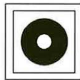
R. PULSADOR DE ALARMA
