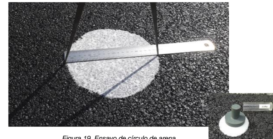
Figura 19. Ensayo de círculo de arena
