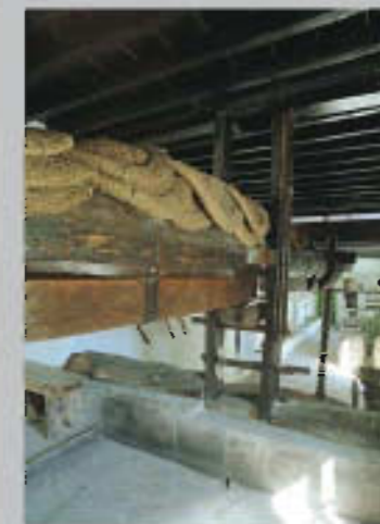
Prensa de viga del Lagar de Torrijos, Málaga.
