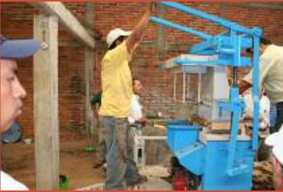
SANTA FE DE LA LAGUNA: Fabricando ladrillos de adobe.
