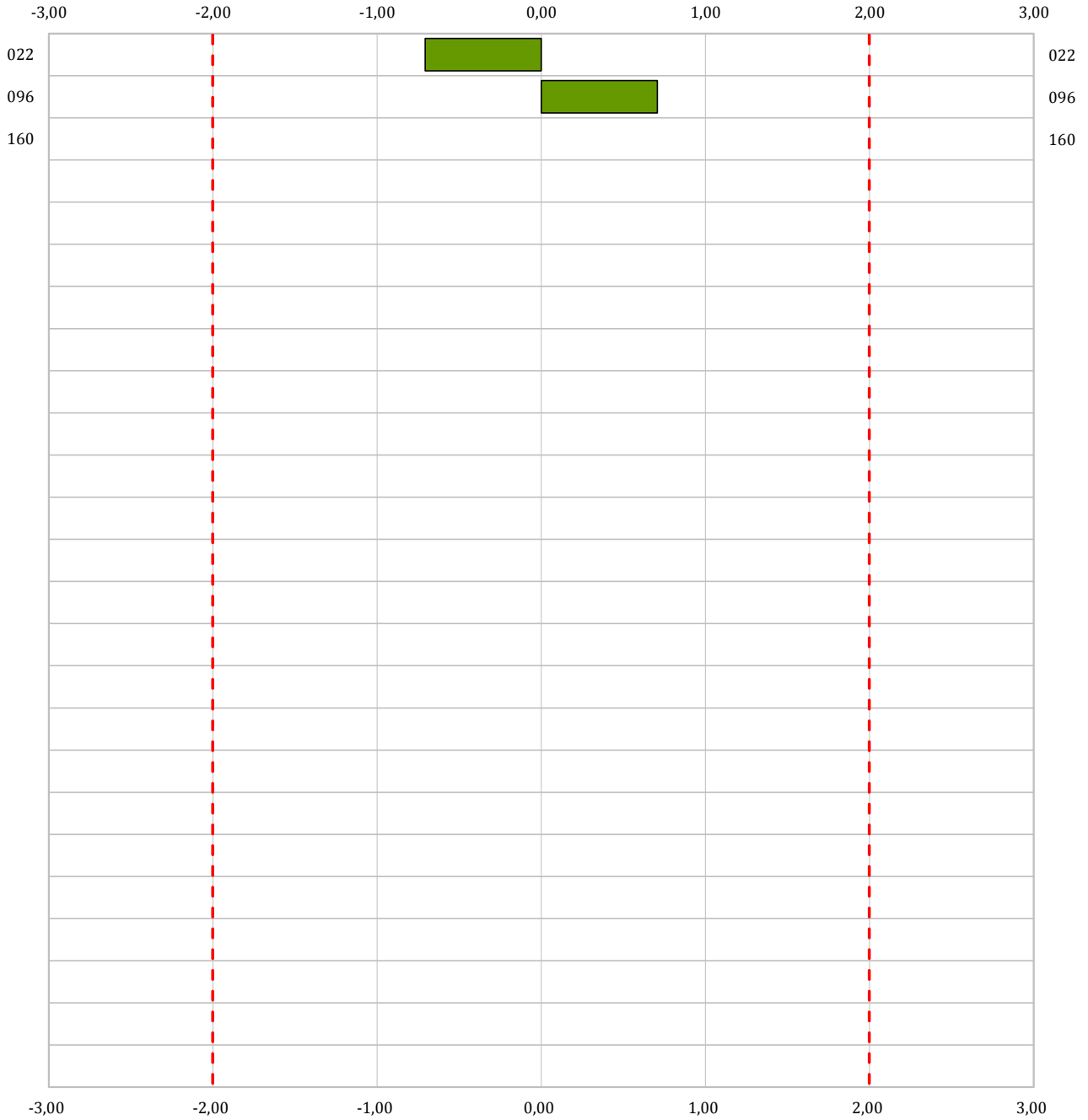
Gráfico 01. Diagrama Z-Score de los resultados aportados por los laboratorios. Los resultados se considerarán satisfactorios si el valor absoluto del Z-Score es menor o igual a 2 unidades, dudoso si está comprendido entre 2 y 3 unidades e insatisfactorio si es mayor o igual a 3 unidades.
