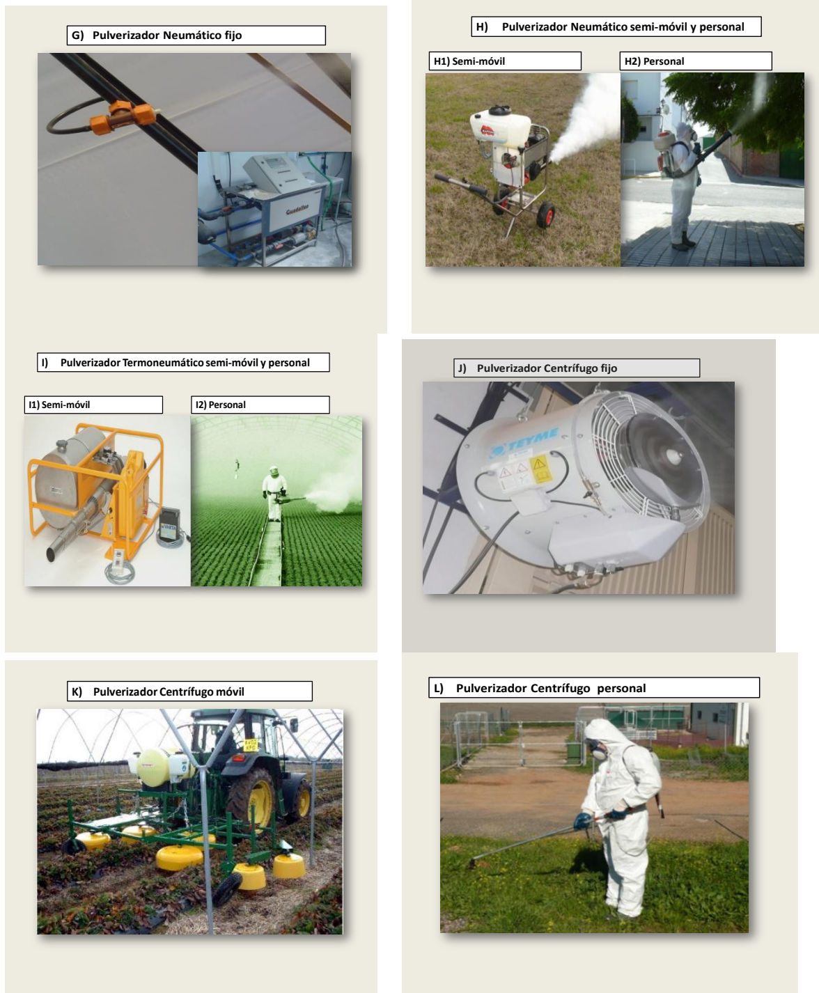
Figura 2. Tipología de equipos e instalaciones de aplicación de productos fitosanitarios en invernaderos (continuación)
