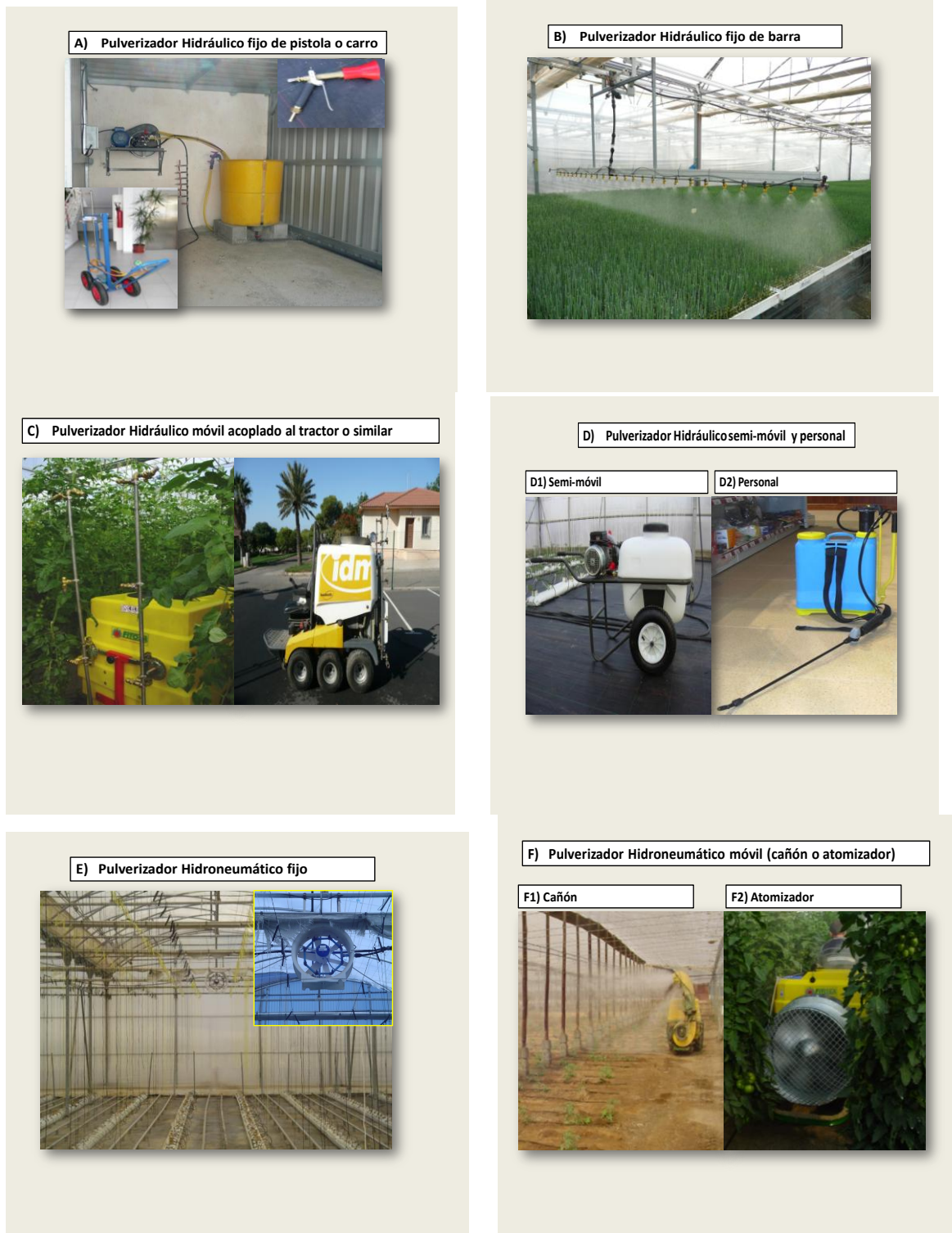
Figura 2. Tipología de equipos e instalaciones de aplicación de productos fitosanitarios en invernaderos
