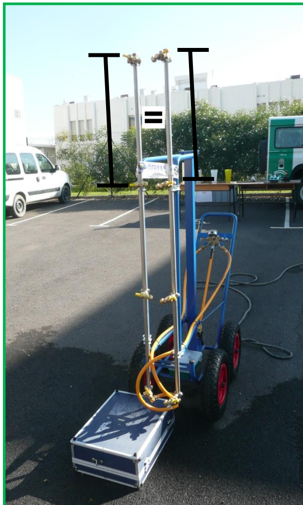
Carro de tratamientos con boquillas situadas a la misma distancia.
