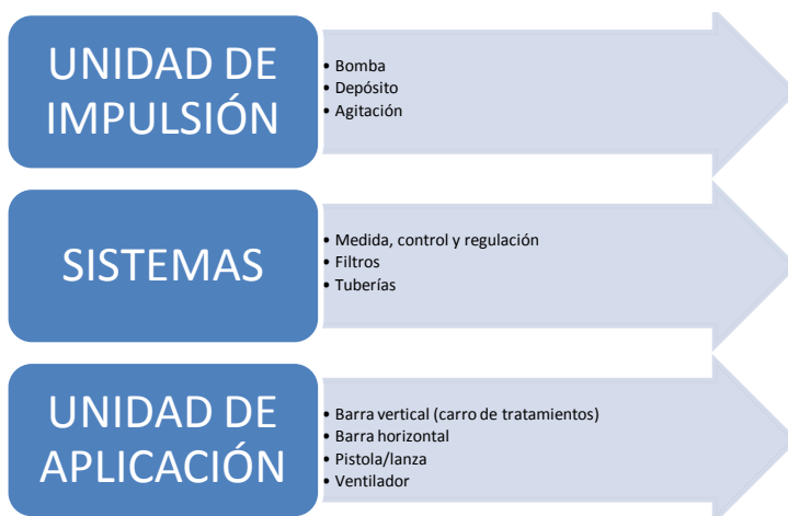
Figura 3. Esquema de los elementos principales de un equipo de pulverización en un invernadero.
