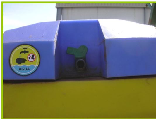
Fig. 12. Válvula de vaciado del depósito.
