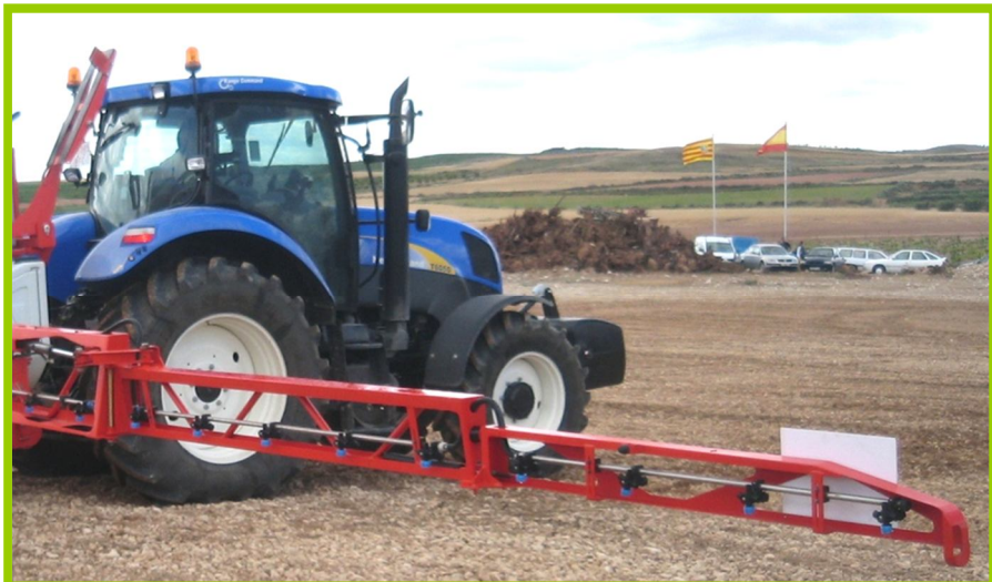
Fig. 19. Boquillas iguales en toda la barra.
