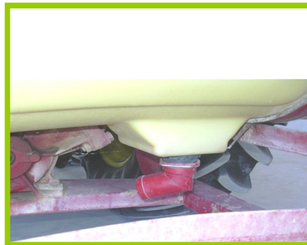
Fig. 11. Válvula de vaciado del depósito.
