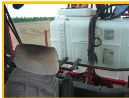
Fig. 9. Indicador de nivel visible desde el puesto del conductor.
