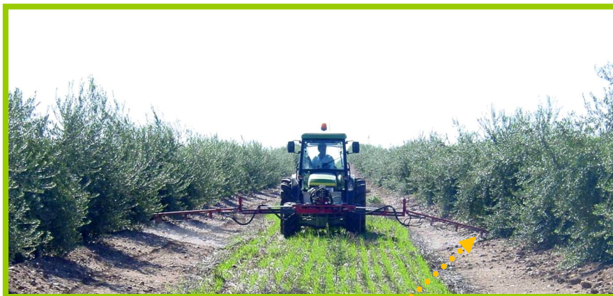
Fig. 34. Máquina que no cumple el requisito de horizontalidad.
