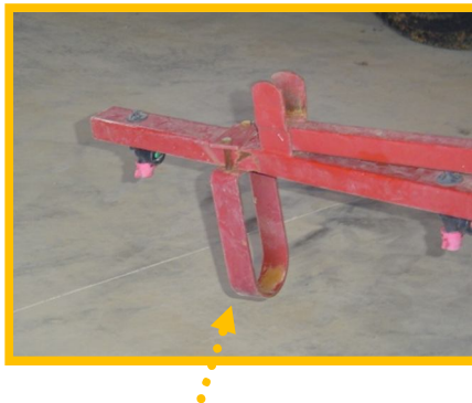
Fig. 18. Dispositivo de protección de las boquillas extremas.
