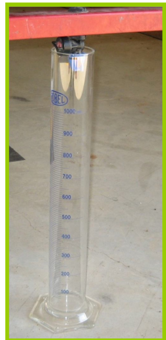
Fig. 36. Cálculo del caudal de una boquilla con una probeta graduada usando cronómetro.
