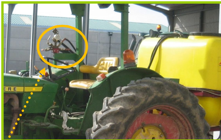
Fig. 14. Tubería mal situada en el puesto de conducción, con riesgo de provocar accidentes por fugas a alta presión.
