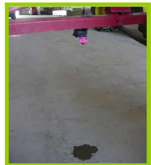
Fig. 30. Dispositivo antigoteo en mal estado.
