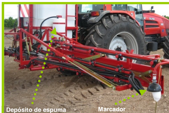
Fig. 25. Circuito de espuma para marcar las pasadas.
