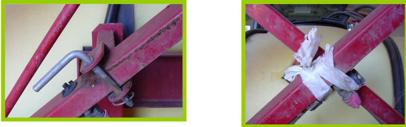
Fig. 17. Dispositivo correcto (izquierda) e incorrecto (derecha) de bloqueo..
