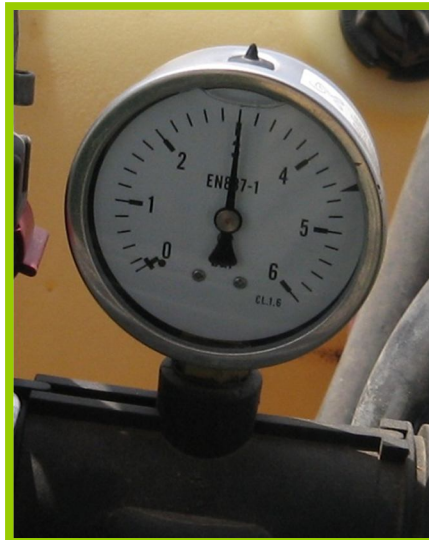
Fig. 13. Manómetro apropiado para un rango de presiones de 0 a 5 bar.
