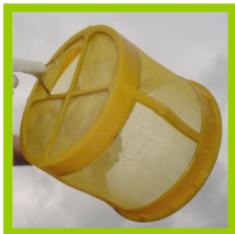
Fig. 5. Filtro en mal estado: permite el paso de partículas que pueden dañar algún elemento del pulverizador.
