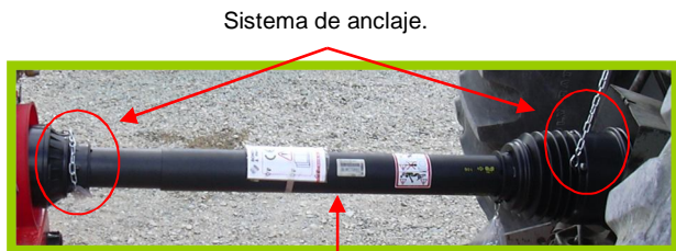
Fig. 4. Resguardo del eje de transmisión en buen estado y sistema de anclaje.
