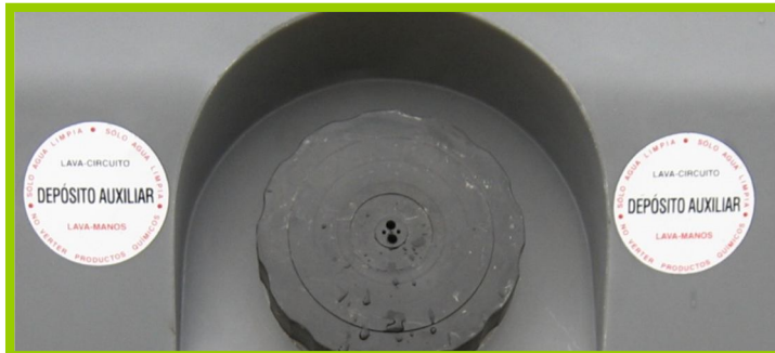
Fig. 26. Depósito auxiliar lavacircuito.
