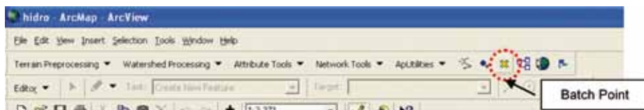
Figura 11. Creaci3n del fichero de puntos que va a indicar el punto de salida de la subcuenca de estudio.
