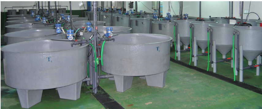
Figura 5.6. Tanques circulares de 500 L con fondo plano aptos para agua de mar del IFAPA Centro Agua del Pino. Encima de los tanques, los recipientes azules que se observan son comederos automáticos, utilizados en el preengorde y engorde del parracho.
