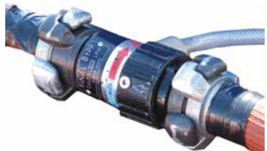
Figura 16. Mezclador conectado entre dos tramos de manguera.
