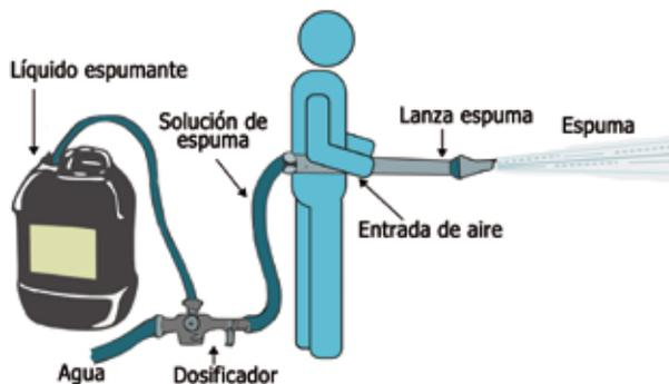
Figura 43. Mezclador de espuma.
