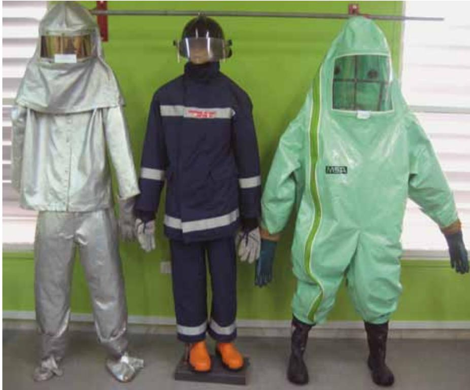
Figura 36. Equipo de aproximación. Equipo de protección química. Equipo de penetración.
