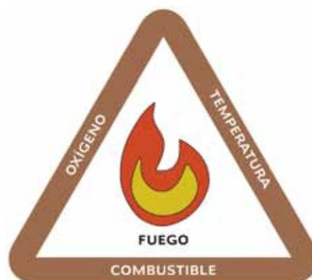
Figura 5. Triángulo del fuego.
