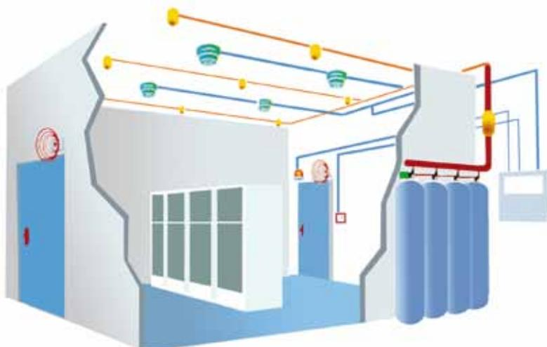
Figura 32. Instalación fija de CO<sub>2</sub> de baja presión.
