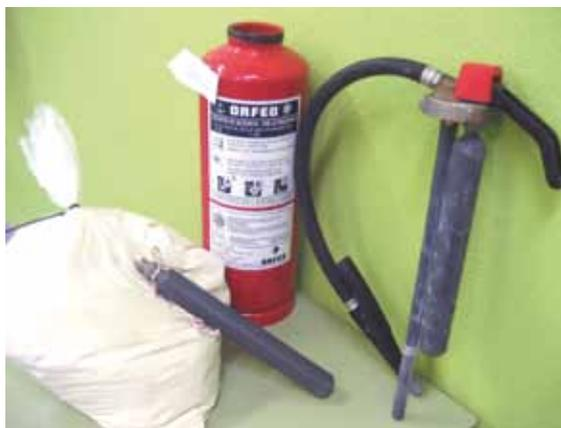
Figura 24. Sifón de extintor y su carga de polvo.
