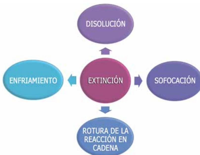
Figura 14. Mecanismos usados para la extinción de incendios.
