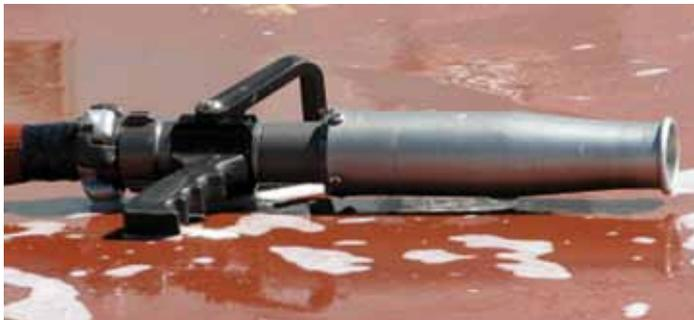
Figura 15: Boquilla de espuma.
