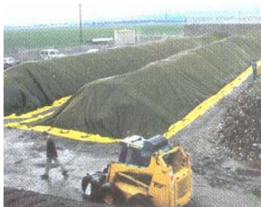
Ilustración 2. Pilas estáticas con aireación forzada y cubierta de lona
