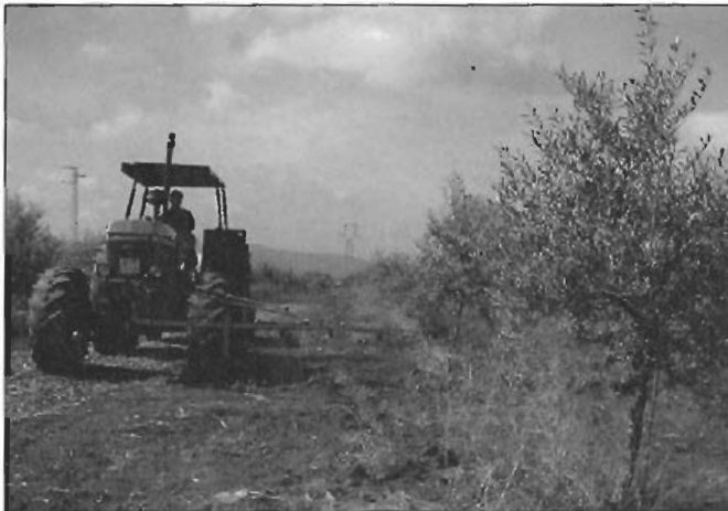
Foto 6.- Pulverizador de barra tratando cubierta vegetal
