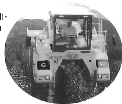
▲ Cosechadora de aceituna. Como puede verse, la máquina pasa por encima de los árboles, sin perjudicarlos. (Foto: Todolivo).
