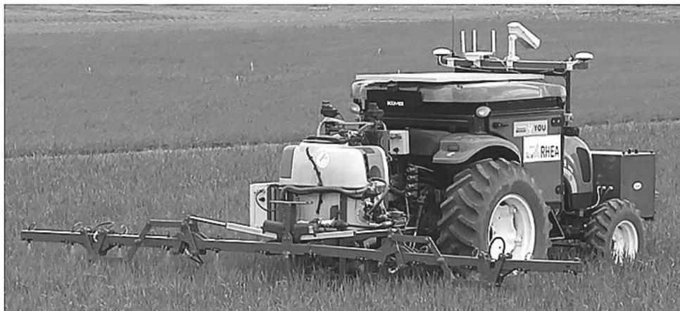
Figura 5. Equipo autónomo para la aplicación localizada de herbicida (Proyecto RHEA-[www.rhea-project.eu](http://www.rhea-project.eu)).
