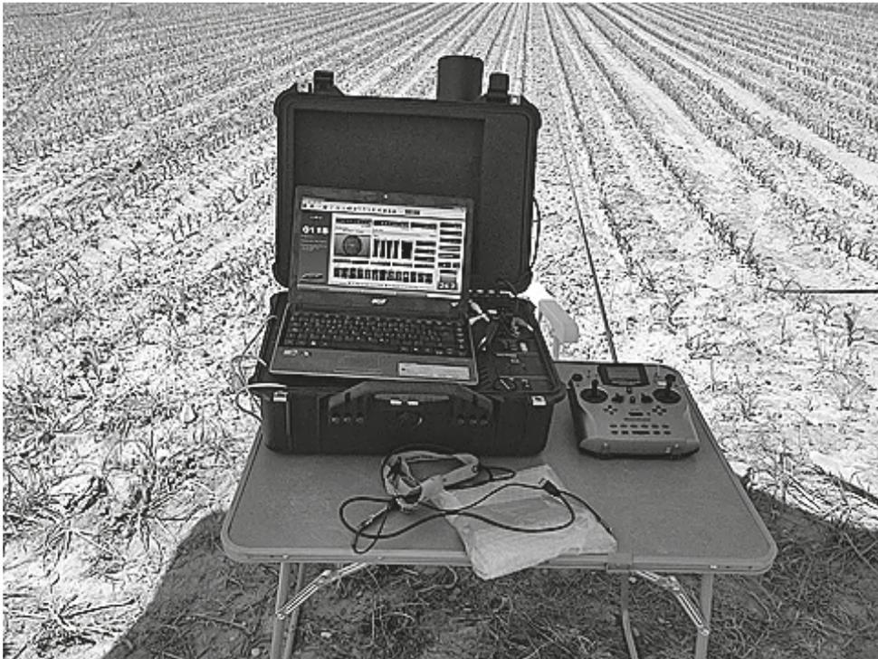
Figura 9. Estación base para control del vuelo ejecutado por un dron cuadrotor, modelo md4-1000 (Torres-Sánchez et al., 2013).
