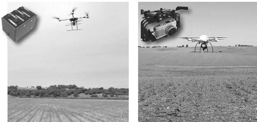
Figura 7. Ejemplos de UAV equipado con una cámara multi-espectral (izquierda) y una cámara convencional visible (derecha).
