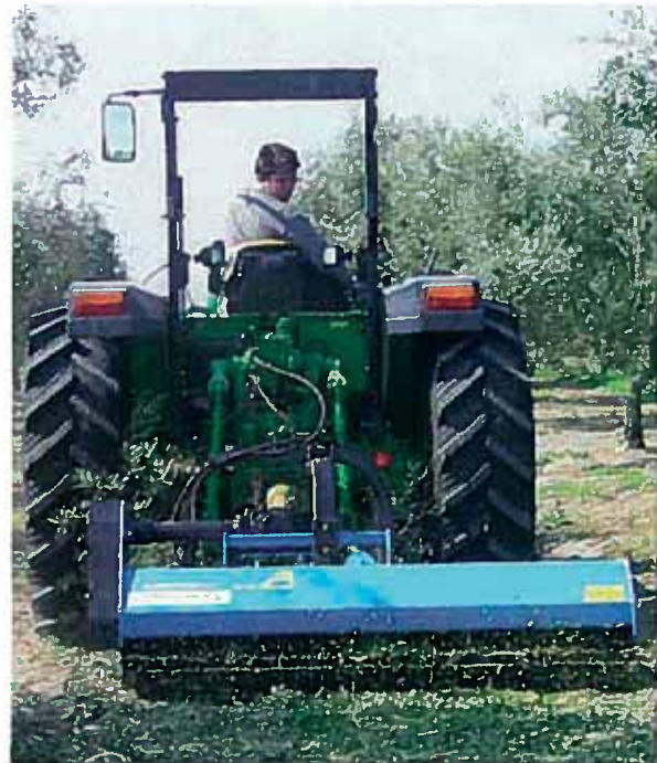
Foto 18: Trituradora de ramón autoalimentada.
