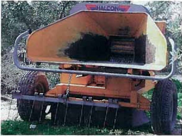
Foto 17: Picadora de ramón de alimentación manual.
