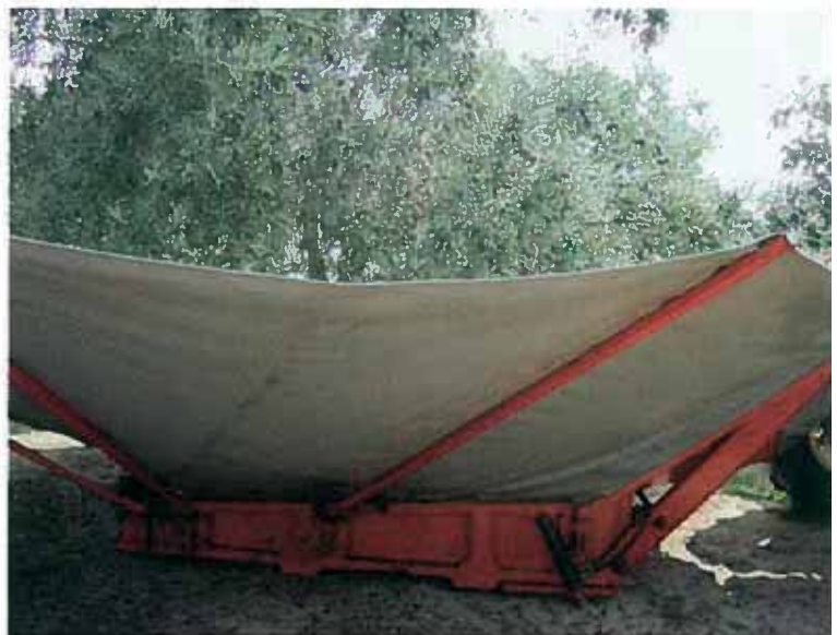
Foto 42: Vibrador con paraguas invertido trabajando.
