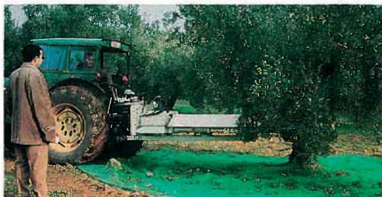
Foto 25. Vibrador unidireccional de troncos biela-manivela.
