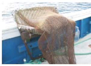
Draga VAN Veen y rastro con doble malla empleados para la toma de muestra de sedimento y la captura de fauna bentónica respectivamente
