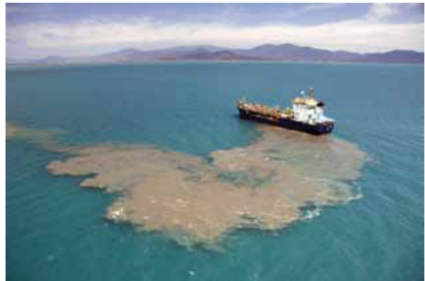
Figura 53. Fallo en el equipo separador
