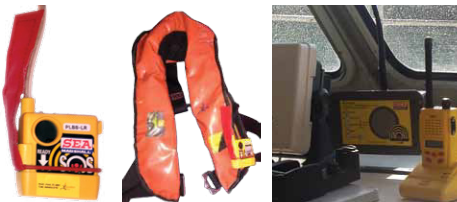
Figura 55. Radiobaliza personal, chaleco inflable con radiobaliza personal y unidad base para localización de hombre al agua
