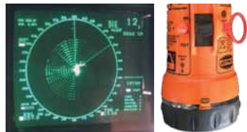
Figura 48. Modo TEST y activación del SART
