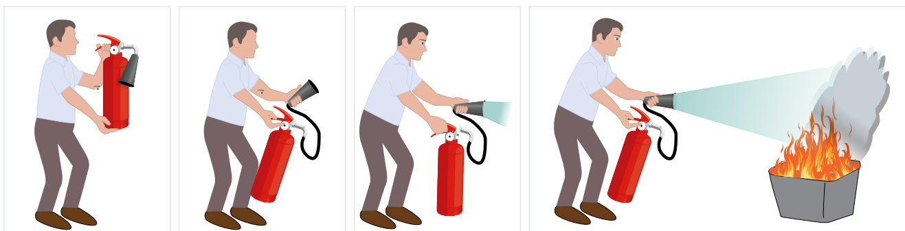
Figura 43. Procedimiento con un extintor
