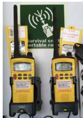
Figura 42. Aparato radioeléctrico portátil, cargador y batería
