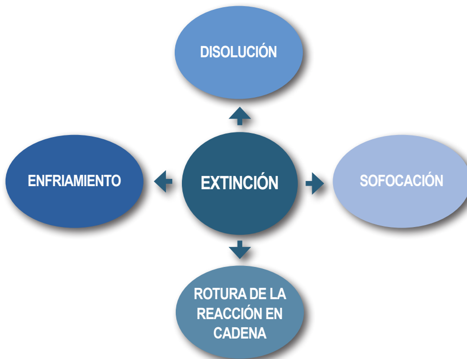
Figura 14. Mecanismos usados para la extinción de incendios.
