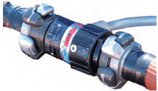
Figura 16. Mezclador conectado entre dos tramos de manguera.
