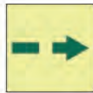
Ruta secundaria de evacuación
