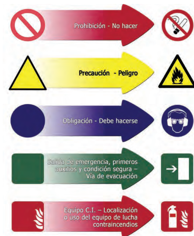
Figura 4. Señalización de los equipos y medios contra incendios.
