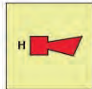
Bocina de alarma de halón
