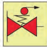
Válvulas de aceite/combustible con control remoto
