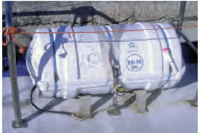
Figura 4. Ubicación de balsa salvavidas en cubierta y en zona despejada.
