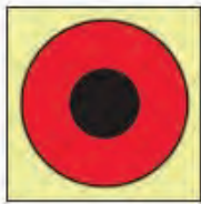
Pulsador de alarma de incendios
