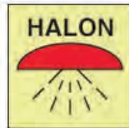
Espacio protegido por halón 1301
