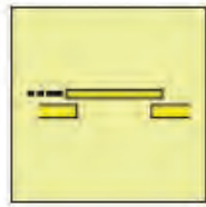
Puerta de incendios clase "B"
