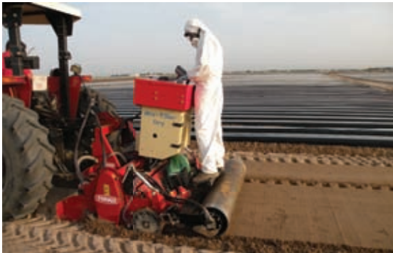
Figura 13. Maquinaria de aplicación con rodillo de compactación
