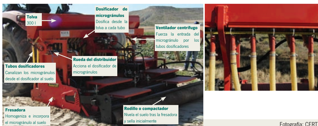
Figura 12. Maquinaria para dosificar e incorporar homogéneamente fumigantes sólidos y detalle de los tubos dosificadores
