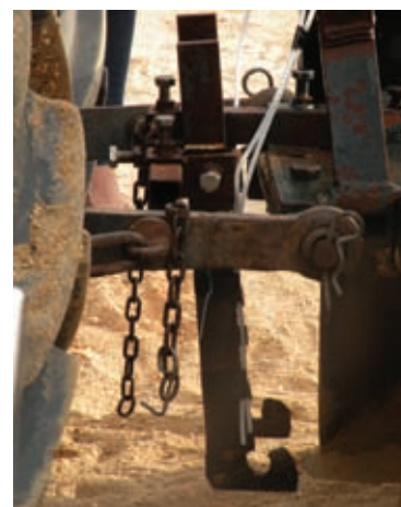
Figura 7. Detalle de reja aplicadora
