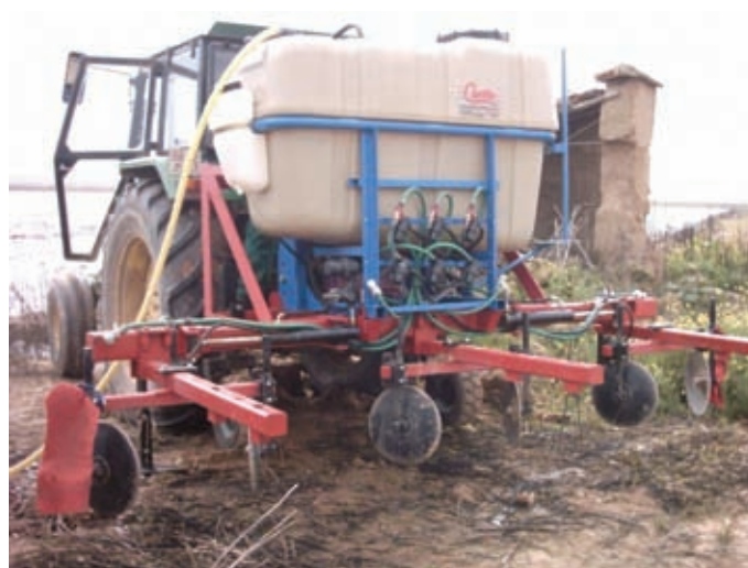
Figura 10. Inyección con bomba dosificadora, usada en terrenos de plantación de árboles y viña
