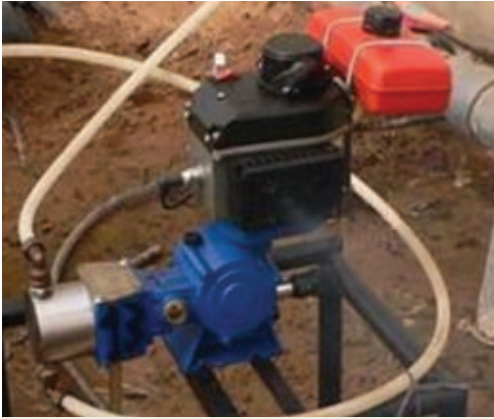
Fotografía: Dow AgroSciences Ibérica S.A. Figura 3. Bomba dosificadora
