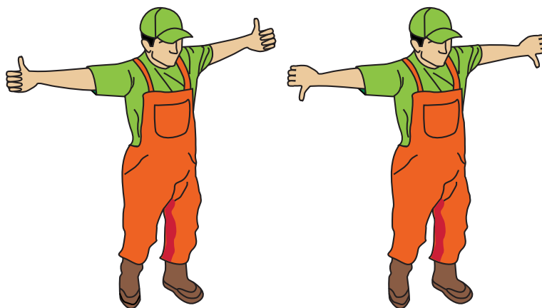
Figura 17. Comunicación en la operación de izada
