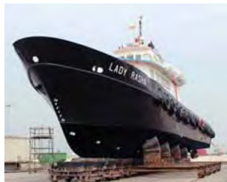
Figura 1. Barco con pintura antifouling
