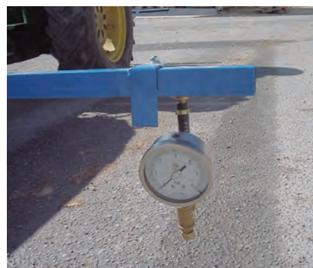
Figura 2. Medida de la presión de trabajo
