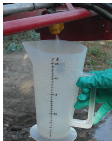
Figura 7. Medida del caudal suministrado por las boquillas de tratamiento
