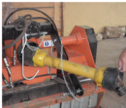
Figura 4. Toma de fuerza completamente protegida
