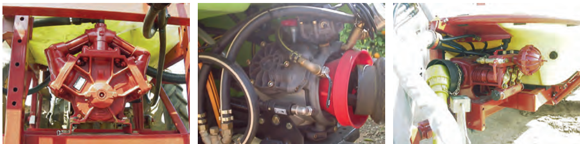
Figura 7. De izquierda a derecha: bomba de membrana, bomba de pistón-membrana y bomba de pistón
