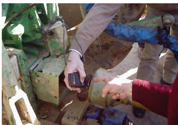
Figura 8. Medida de las revoluciones en la toma de fuerza con un tacómetro de mano
