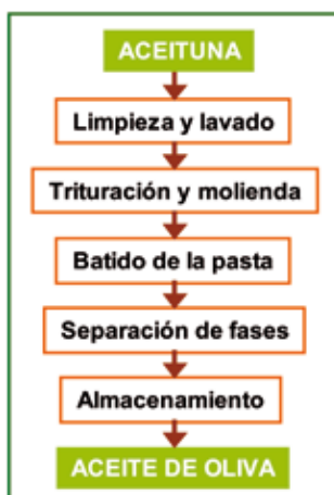
Figura 2. Fases del proceso de elaboración del aceite de oliva.
