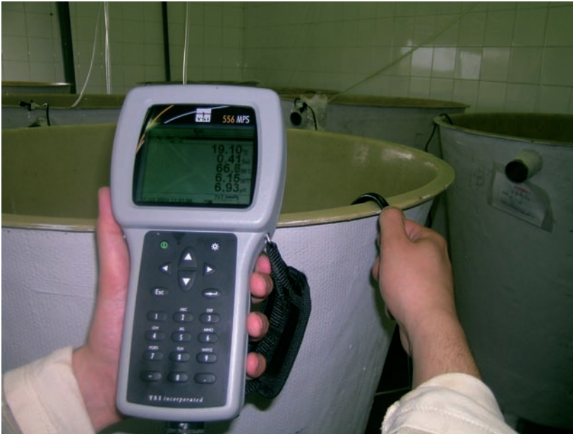
Multisonda para la valoración de parámetros como salinidad, pH, temperatura y oxígeno disuelto Multisonda para avaliação de parâmetros como salinidade, pH, temperatura e oxigénio dissolvido
