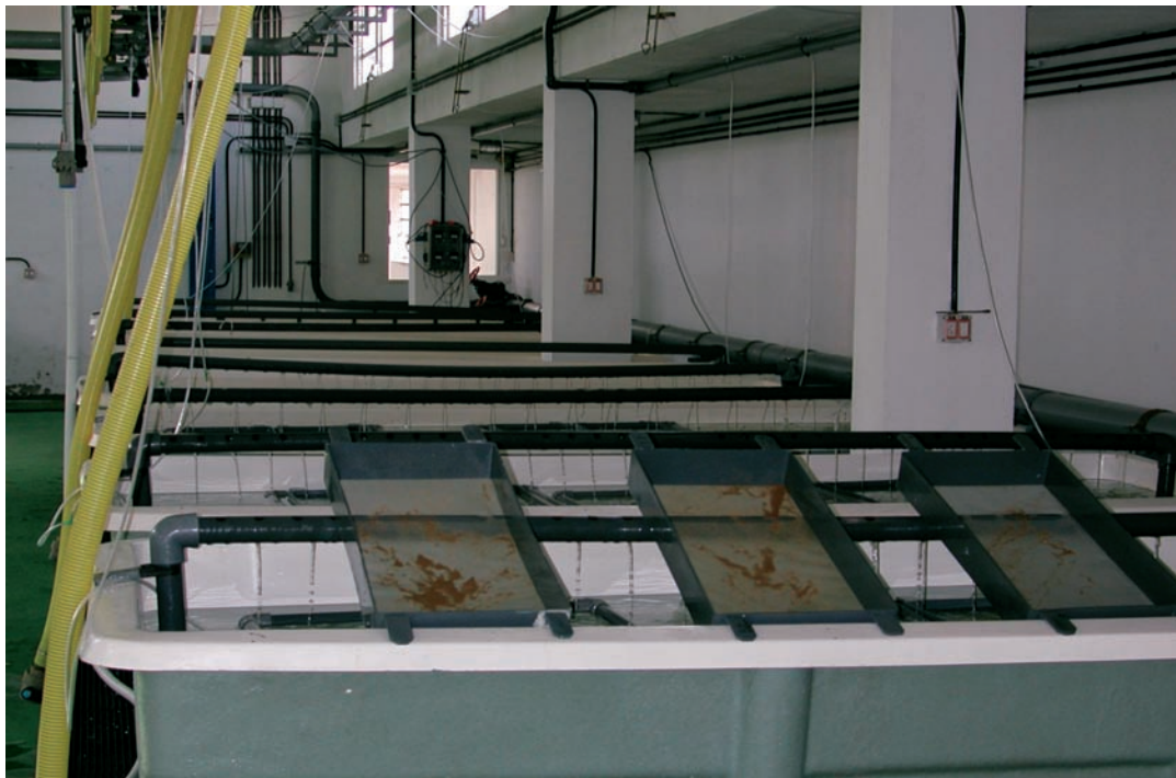
Tanque de cultivo de postlarvas de 2000 litros con bandejas rectangulares Tanques de cultivo de pós-larvas de 2000 litros, com bandejas rectangulares
