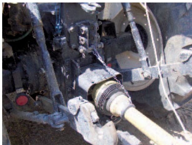
Figura 11. Resguardo del eje de transmisión en buen estado y sistema de anclaje
