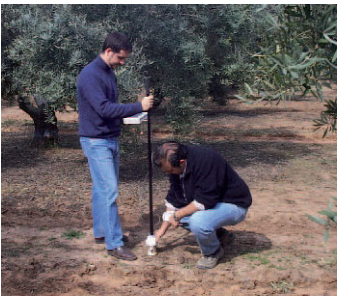
Figura 6. Los sensores permiten estimar la evolución del contenido de agua del suelo en los puntos muestreados
