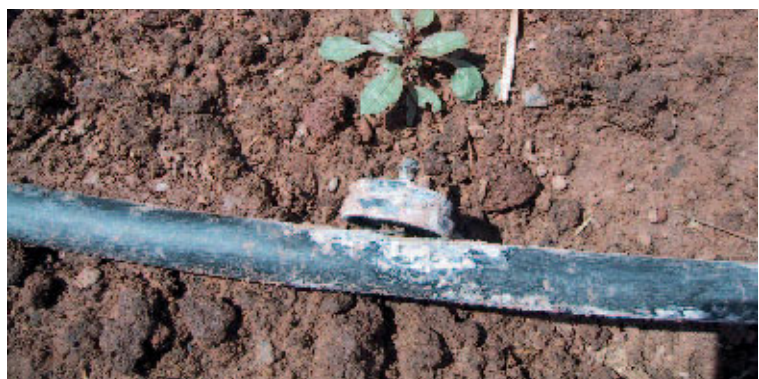
Figura 4. Obturaciones químicas de goteros provocadas por la precipitación de carbonato cálcico. Pueden ser corregidas disminuyendo el pH del suelo mediante el aporte de ácidos
