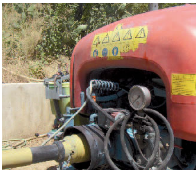
Figura 12. Funcionamiento de dispositivos de conexión y desconexión, manómetro calibrado y sin fugas
