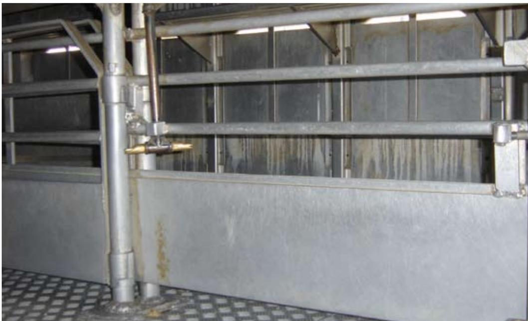
Figura 4. Bebedero en el interior de un camión de transporte de ganado
