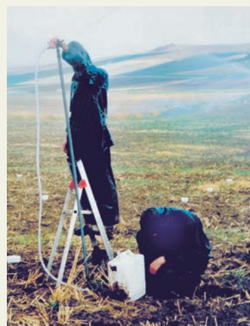
Figura 9. Medida del caudal que suministra un aspersor. Se llena el bidón hasta la marca (véase la goma colocada en la boquilla del aspersor) y se mide el tiempo que tarda en llenarse.
