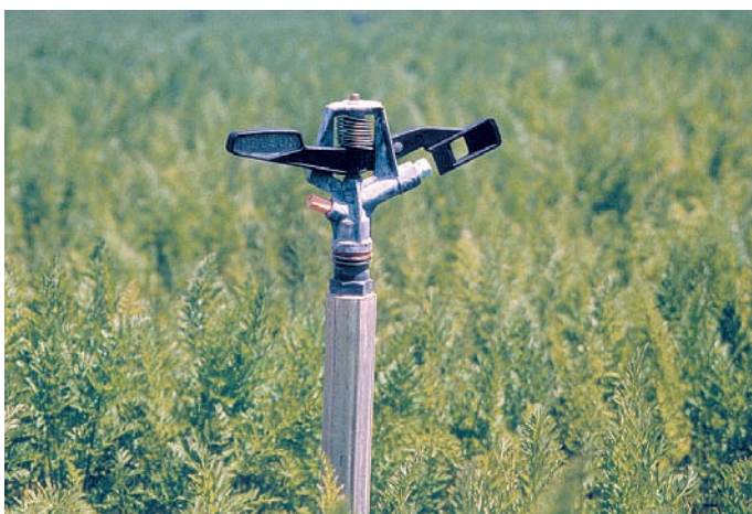
Figura 11. Aspersor circular de impacto en cultivo de zanahorias.
