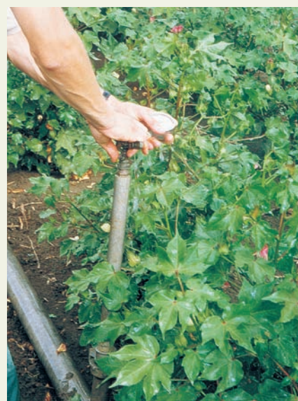
Figura 8. Medida de la presión en un aspersor utilizando un manómetro.
