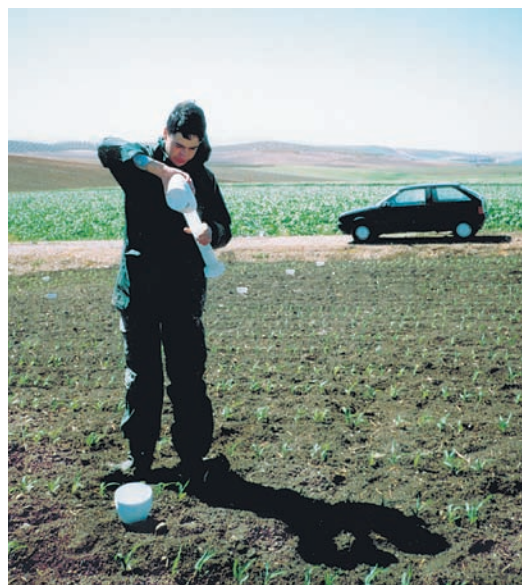
Figura 5. La cantidad de agua que se recoge en cada vaso pluviométrico se mide vertiéndola en una probeta o vaso graduado.
