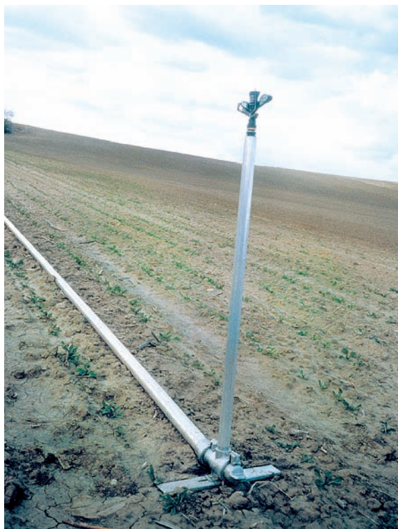
Figura 9. Tubo portaaspersor en el que se observa el estabilizador.
