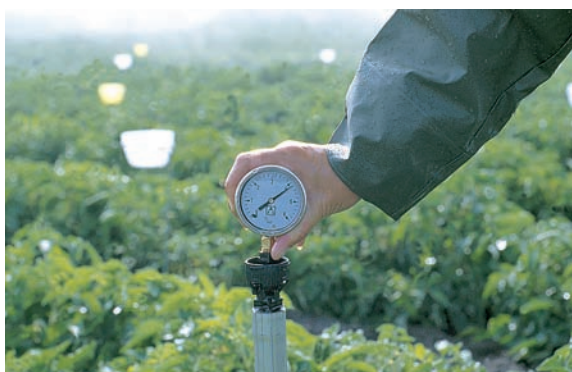
Figura 2. Medida de la presión en la boquilla de un aspersor utilizando un manómetro.
