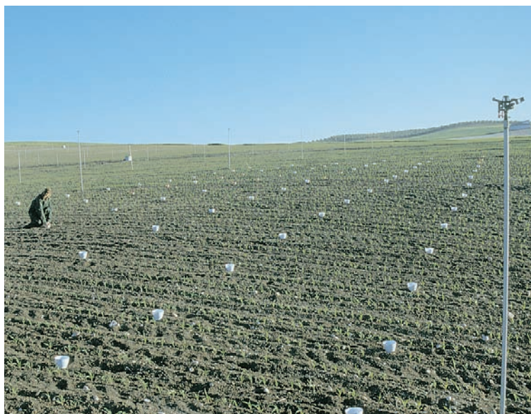
Figura 4. Vasos pluviométricos colocados sobre el suelo cada 3 metros para la evaluación de un sistema de aspersión fijo.
