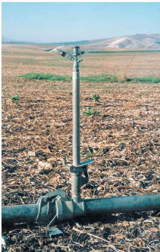
Figura 2. Usando estabilizadores en los tubos de aspersión, los portaaspersores permanecen verticales durante el riego.
