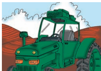
Figura 4. Cabina de tractor con dispositivo de filtrado del aire
