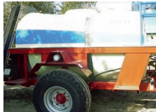
Figura 3. Depósito de poliéster
