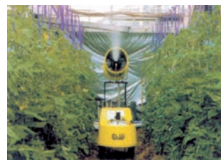
Figura 6. Nebulizador en frío, instalado en el interior de un invernadero
