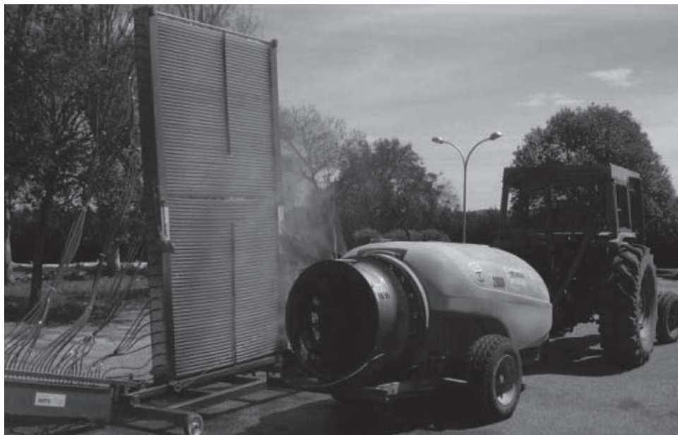
Figura 4. . Banco de distribución vertical
