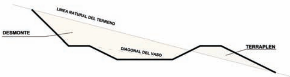
A) Exceso de desmonte sobre terraplén
