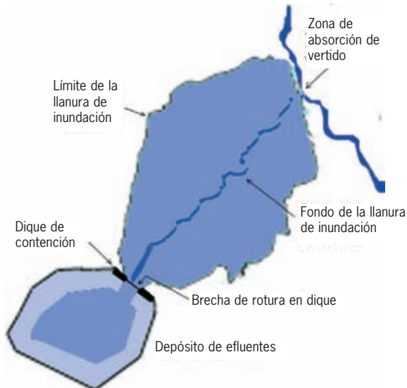
Figura 3.2.5. Rotura de dique de depósito de efluentes provocando una inundación aguas abajo, y siendo absorbido el vertido finalmente por el arroyo o río que se encuentra unos kilómetros aguas abajo.
