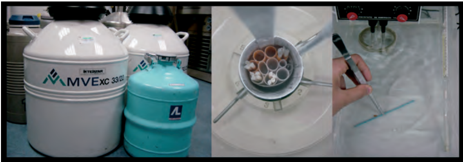
Figura 20. Contenedores de nitrógeno líquido (izquierda), detalle de canastera con pajuelas congeladas (centro) y descongelación en agua a temperatura ambiente (derecha).
