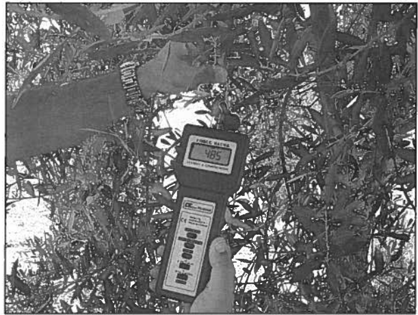
Figura nº 3: Es clave poder hacer un seguimiento de la fuerza de retención de la aceituna y para ello es clave poder medirla con un dinamómetro digital o con uno manual de precisión.
