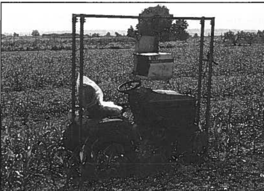
Figura 5: Minitractor cortacésped modelo John Deere LX 289 escogido para el Proyecto. Foto realizada durante pruebas de campo en cultivo de maíz en las instalaciones del CITA, en Montañana, Zaragoza.
