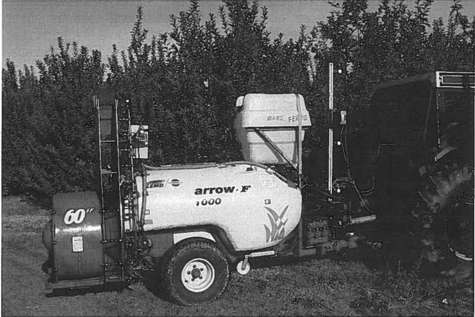
Figura 2.- Prototipo de pulverizador Fluxpro equipado con sensores para la caracterización de la vegetación y con tecnología de aplicación variable para el ajuste de la dosis de producto en tiempo real.
