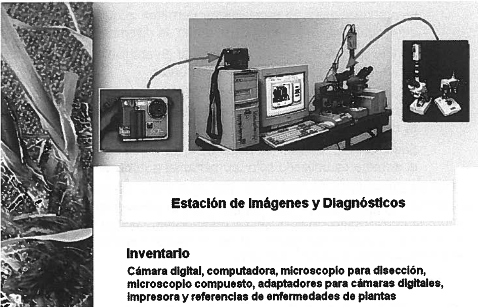
Figura 2. Equipo completo para la captura, procesado y envío de imágenes.
