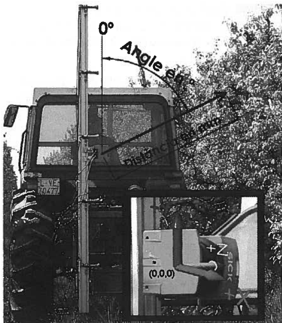
Figura 5. Dispositivo empleado para la caracterización estructural de plantaciones, capaz de operar simultáneamente con sensores US y LIDAR. Obsérvense los cinco sensores US, cada uno de los cuales registra datos a su correspondiente nivel y el detalle del cabezal del sensor de láser LIDAR, operando en un plano vertical con un ángulo de incidencia próximo a los 180º (Llorens, 2005)
