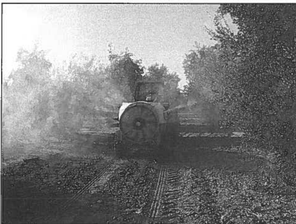
Figura nº 4 : Se debe de aplicar CLOUD con un atomizador correctamente calibrado para aportarnos el volumen de caldo calculado y para asegurar una correcta distribución del caldo y un mojado del fruto a punto de goteo.
