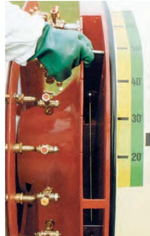
Figura 17. Barra portaboquillas en un pulverizador hidroneumático.
