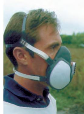
Figura 10. Equipo de presión negativa autofiltrante
