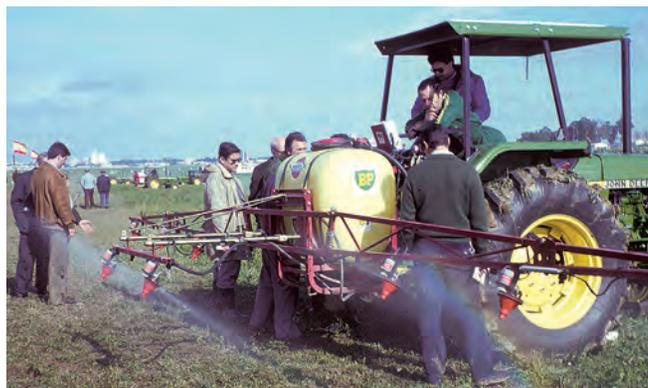
Figura 18. Pulverizador centrífugo suspendido de los tres puntos de enganche del tractor.
