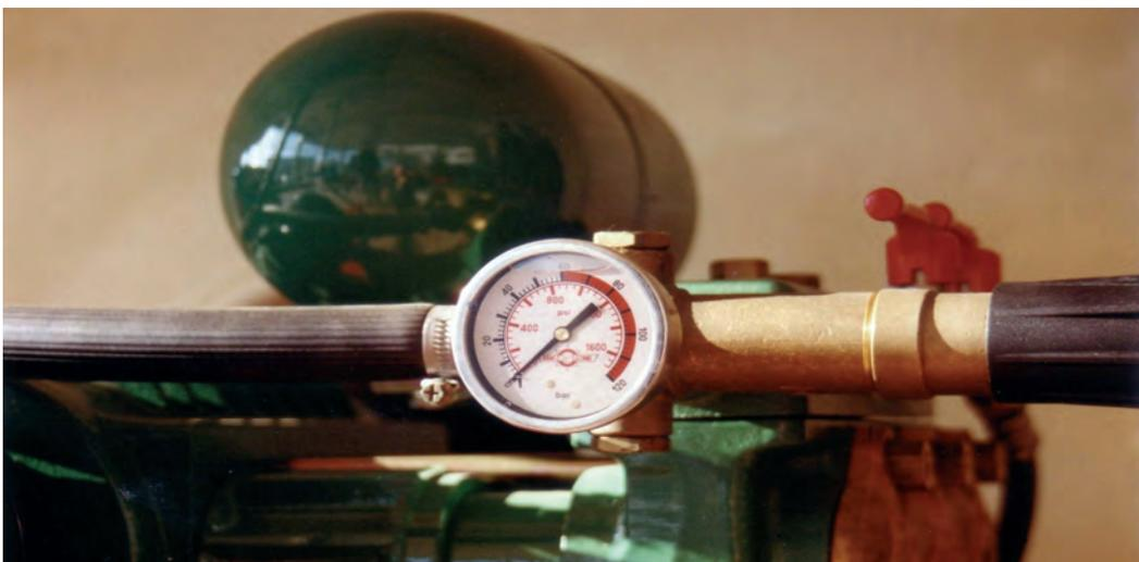
Figura 3. La presión de trabajo de la maquinaria deba ajustarse en función del tipo de boquilla
