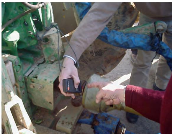
Figura 7. Medida de revoluciones en la toma de fuerza con un tacómetro de mano.
