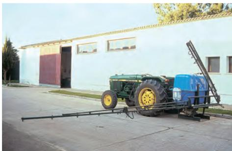
Figura 14. Barra portaboquillas extendida
