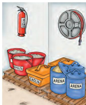
Figura 6. Disposición de las medidas de seguridad necesarias en los locales de almacenamiento
