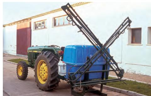
Figura 15. Barra portaboquillas plegada preparada para el transporte
