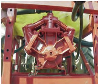
Figura 7. Bomba de membrana
