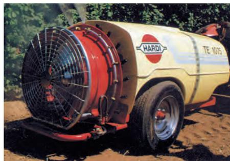
Figura 16. Pulverizador hidroneumático o atomizador
