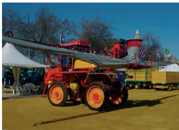
Figura 4. Pulverizador asistido por aire (zancudo)
