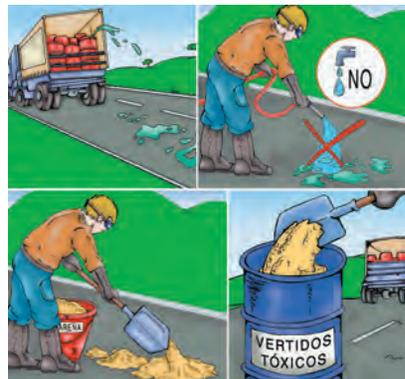
Figura 2. Los vertidos de derrames serán eliminados de forma controlada, utilizando el equipo de protección necesario
