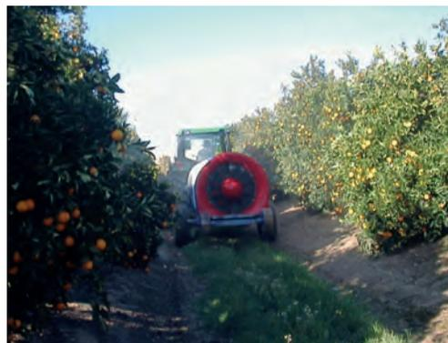
Figura 2. Pulverizador hidroneumático
