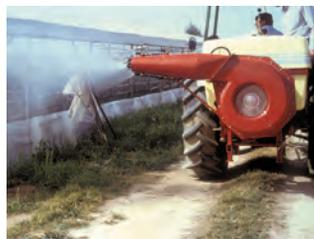
Figura 5. Cañón o pulverizador hidroneumático
