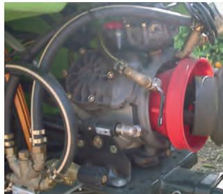
Figura 8. Bomba de pistón-membrana
