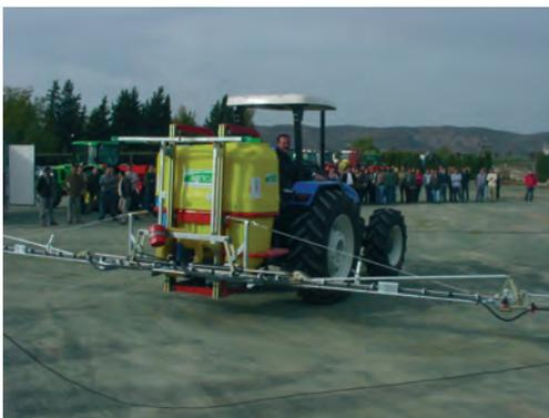
Figura 1. Pulverizador hidráulico
