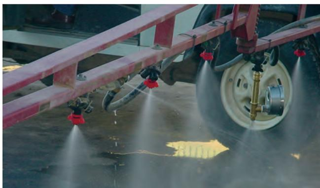
Figura 3. Tubería con fugas. Debe repararse antes de almacenar la maquinaria.
