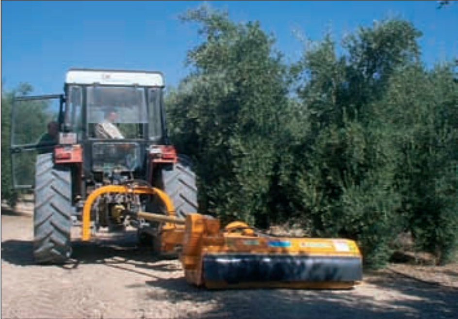
Figura 3: Máquina desbrozadora desplazable del centro del tractor que ofrece la posibilidad de segar las malas hierbas tanto en el centro de las calles como bajo la copa de los olivos, lo cual hace a esta máquina especialmente útil en olivares en cultivo ecológico, en los que no pueden aplicarse herbicidas bajo la copa de los árboles.
