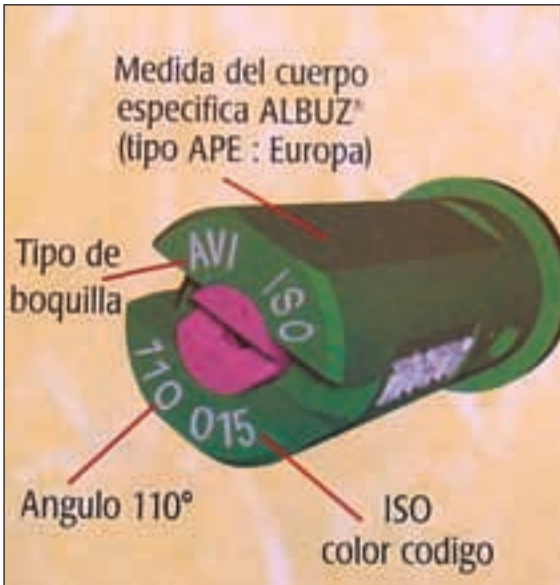
Figura 6: El elemento más importante del equipo de aplicación de herbicidas es la boquilla. Es interesante la utilización de boquillas antideriva de buena calidad, imprescindibles en zonas en las que el viento es frecuente. El aplicador debe tener muy en cuenta las características de la boquilla a emplear: material con el que está fabricado el orificio (se recomienda la cerámica, color rojo en la foto), color del cuerpo junto con el código ISO (nos indica el rango caudales para las diferentes presiones de trabajo), ángulo del chorro plano (recomendable 110° para olivar), además asegurarnos que la boquilla se adapta a la tuerca del porta-boquillas con la que va equipada la barra (utilizar el tipo APE). Ilustración cedida por ALBUZ. Las boquillas deben situarse a 50 cm entre ellas y a una altura mínima de 40 cm sobre el suelo.
