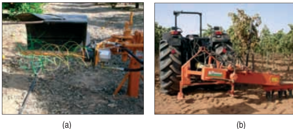
Figura 5. Desbrozadora de latiguillos (a) y sistema de laboreo accionado (b) para la zona de goteo del árbol.
