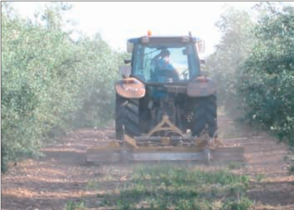
Figura 2: Otro método alternativo al laboreo para el control de las malas hierbas es la siega mecánica. En la foto se observa una máquina desbrozadora de martillos trabajando en un suelo pedregoso en Santa Cruz (Córdoba). Obsérvese que después del paso de la máquina quedan las especies de porte rastrero así como restos de la vegetación segada, que probablemente rebrotarán a partir del cuello, por lo que no cesará la transpiración de la cubierta, siendo necesario en este caso realizar nuevas siegas.
