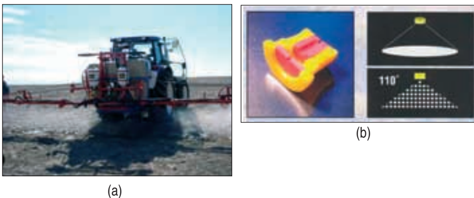
Figura 7. (a) Barra con boquillas anti-deriva (izquierda) y normales (derecha). (b) Boquilla de abanico de 110°.
