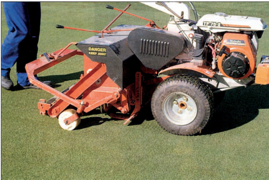
Un terreno encespado. En la foto vemos una maquinaria para “pinchar” suelos compactados en profundidad
