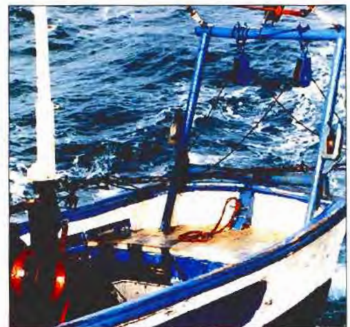
Fot. 24 - Disposición de cables y cadenas en la maniobra de arrastre.
