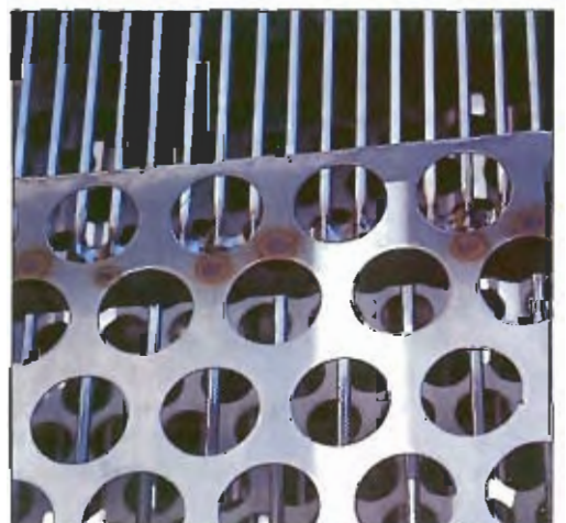
Fot. 71 - Detalle de las distintas zarandas de la cribadora.
