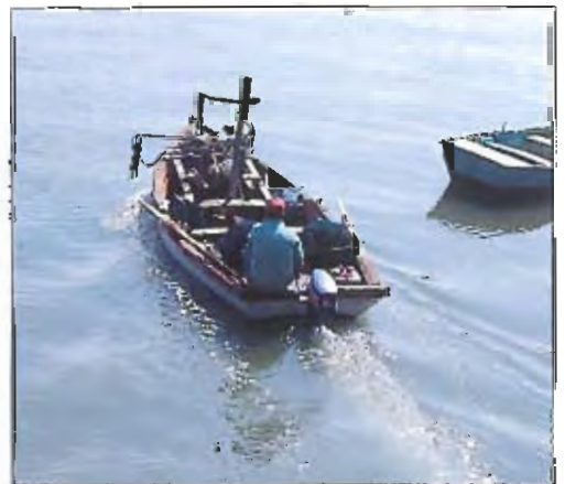
Fot. 4 - Patera de rastro con virador.
