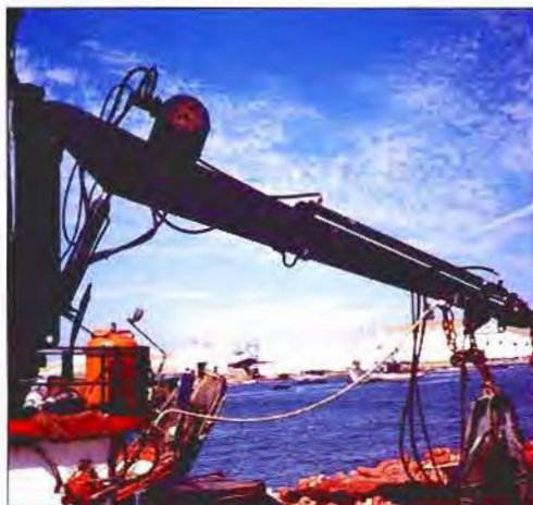
Fot. 24 - Pasteca en pluma hidráulica.
