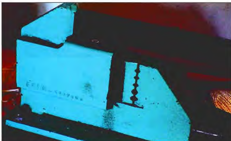
Fot. 1 - Herramienta para elaboración de gazas de las brazoladas, coales o rainales.
