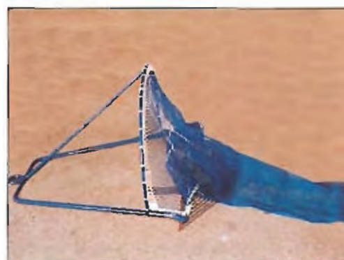
Fot. 33 - Rastro de chirla y coquina. Perfil.
