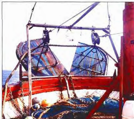
Fot. 21 - Puertas de madera.
