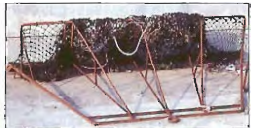
Fot. 55 - Malla del copo y estructura del rastro.
