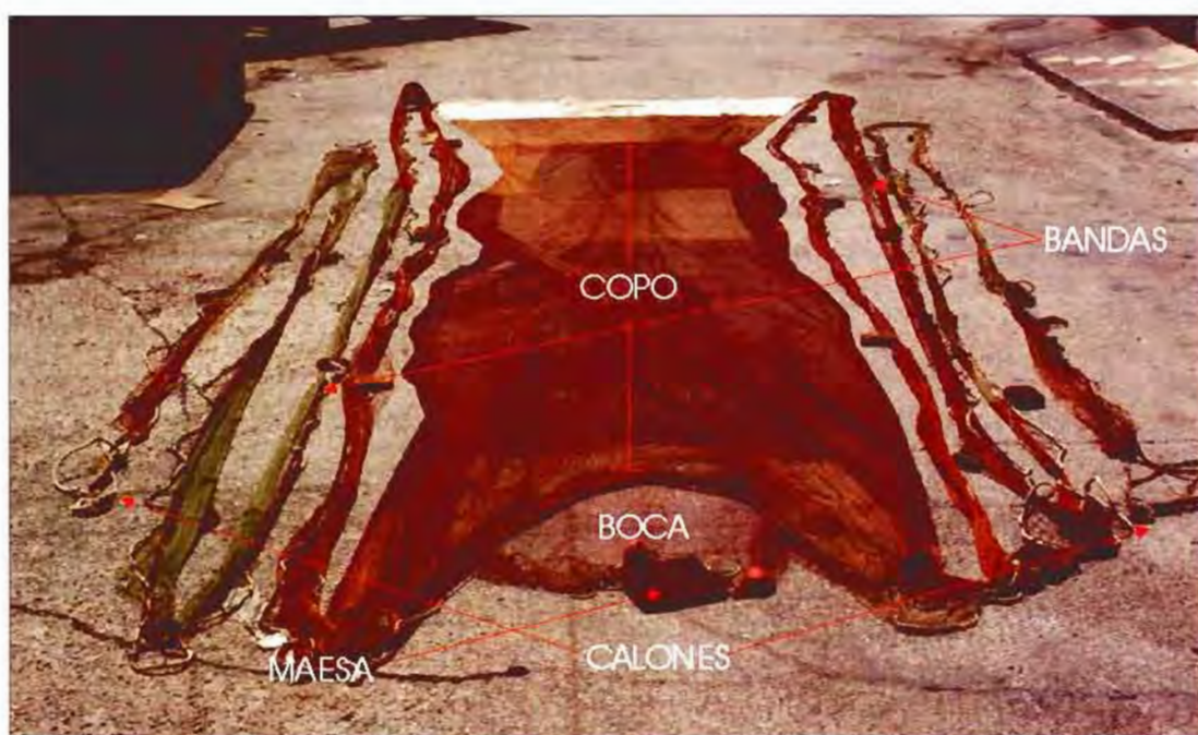
Fig. 1 - Partes de un arte de tiro con copo.
