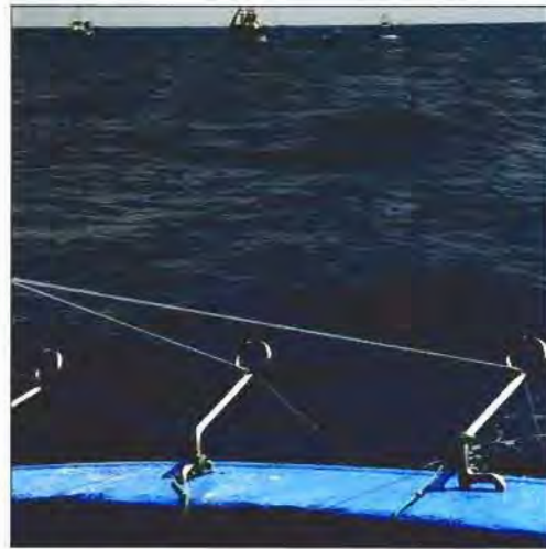
Fot. 152 - Guías para los cordeles de los carretes.
