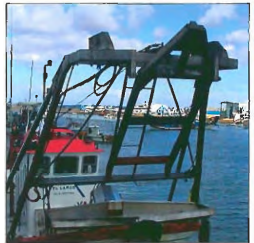
Fot. 74 - Pórtico de la parrilla.
