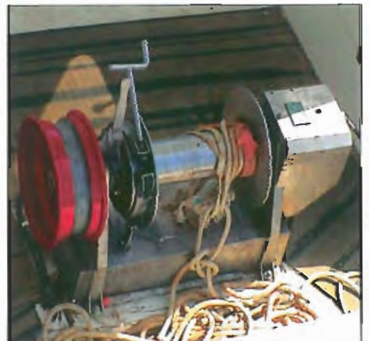
Fot. 20 - Maquinilla para cobrar el rezón o gavilán
