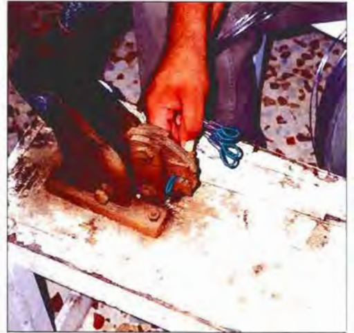
Fot. 9 - Elaboración de las gazas de las brazoladas
