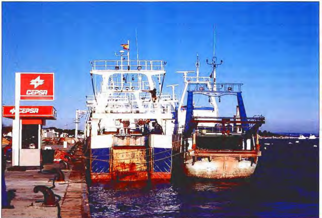
Fot. 49 - Arrastreros de popa con rampa y rodillo.
