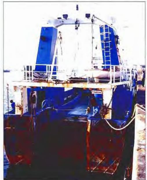
Fot. 3 - Arrastrero de popa con rampa.
