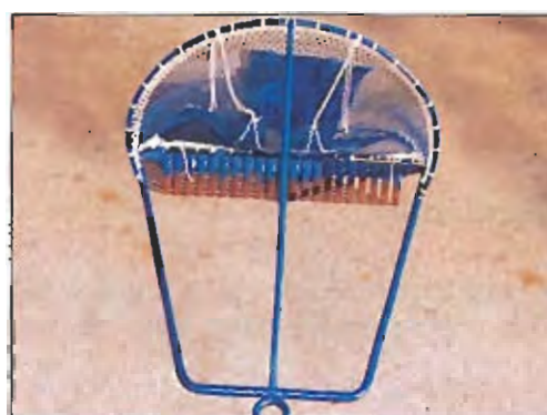
Fot. 34 - Rastro de chirla y coquina. Frente.
