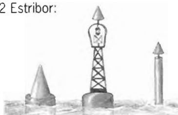
Marcas de estribor
