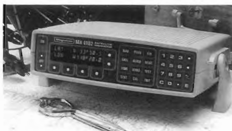
Equipo de navegación por satélite. Cobertura mundial pero no continúa, por lo menos con los satélites TRANSIT.
