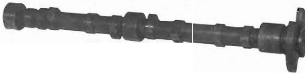
Fig. 23. Camón correspondiente a la válvula de escape del diagrama fig. 22. Detalle de un eje de camones completo.
