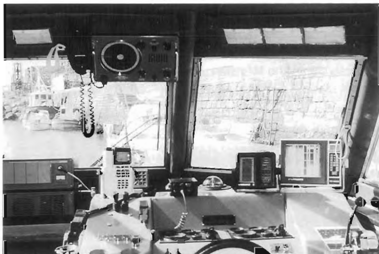
Los radioteléfonos suelen ir instalados en el puente de gobierno
