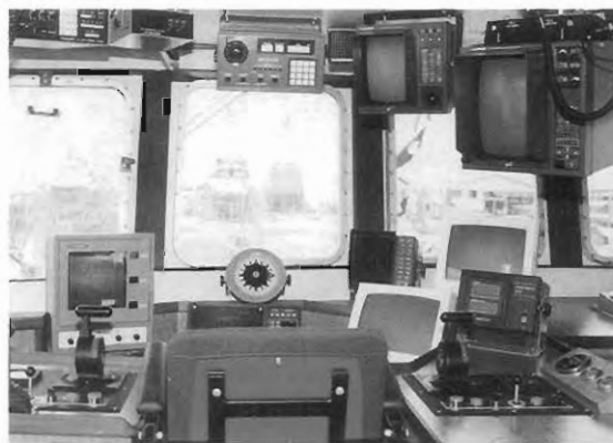
Puente de mando de un buque pesquero. En estos buques es de vital importancia disponer de varias sondas
