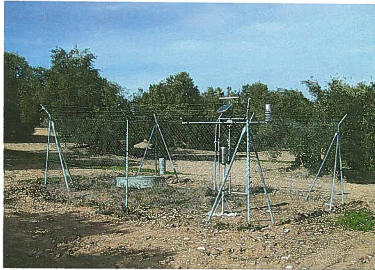
Foto 2.1 Estación meteorológica completa equipada con radiómetro, sensores de humedad relativa, temperaturas, velocidad y dirección del viento y evaporímetro. La captura de datos es automática y registra y almacena las lecturas cada hora. Estación instalada en la Finca La Loma en Jódar (Jaén).
