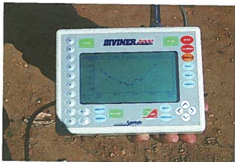
Foto 2.6 Monitor conectado al equipo mostrado en la FOTO 2.5, en el que puede verse en el campo la evolución del contenido de agua en el suelo.
