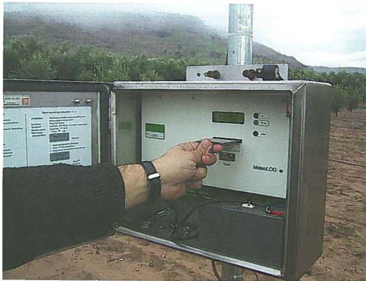
Foto 2.2 Los datos climatológicos almacenados en la estación meteorológica automática son extraídos empleando una tarjeta de memoria para su posterior volcado al ordenador para su procesado.
