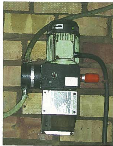
Foto 6.5 Bomba de pistón en una clásica instalación de fertirrigación en olivar. El modelo de la fotografía permite regular con cierta facilidad el caudal inyectado.
