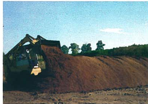
Figura 5. Volteo de la pila de compost con objeto de airear y homogeneizar el producto
