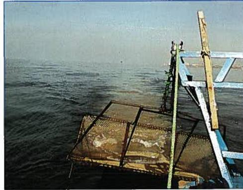
Figura 20: Lavado del copo, en este caso con el barco avanzando hacia atrás.
