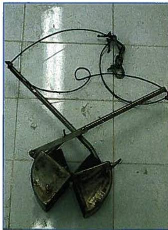
Figura 9: Draga utilizada en los muestreos de sedimento.
