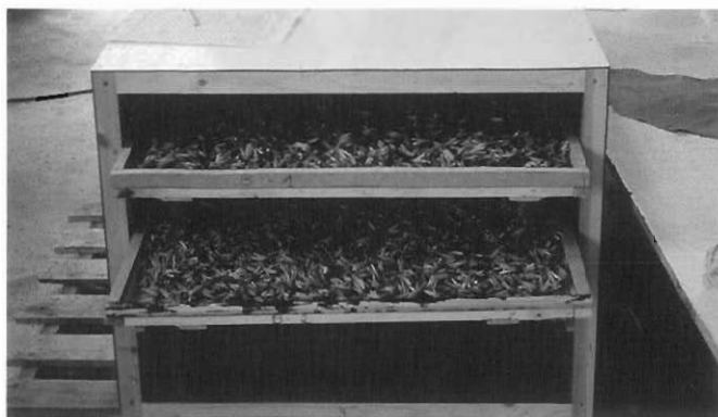
Figura 20. Secadora con bandejas de malla plástica. Vista posterior. Zona de entrada del aire.
