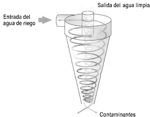
Figura 8. Esquema del funcionamiento de un hidrociclón.
