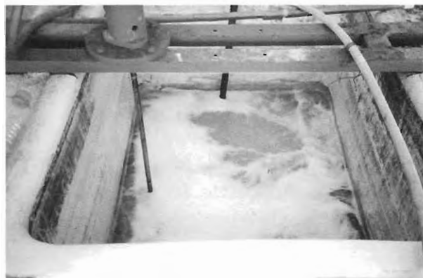
Figura 10. Tanque fertilizante. Se observa el agitador, accionado por un motor eléctrico, usado para homogeneizar la solución nutritiva.
