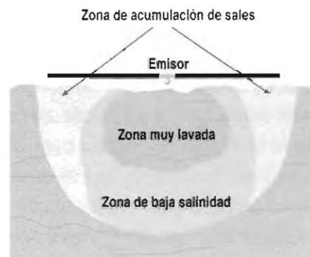
Figura 7. Distribución típica de las sales en riego localizado.
