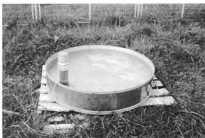
Figura 2. Tanque evaporímetro clase "A" para medir la evapotranspiración de referencia (ETr).
