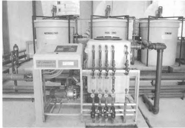
Figura 3. Equipo de fertirrigación automático. Se pueden observar al fondo los depósitos de fertilizante.
