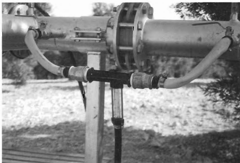
Figura 14. Dispositivo Venturi para inyectar la solución nutritiva al agua de riego.
