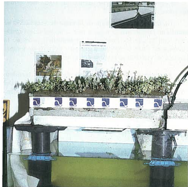
Azotea aljibe, modelo para exposición donde se distingue la capa de agua debajo del drenaje (foto de la autora).
