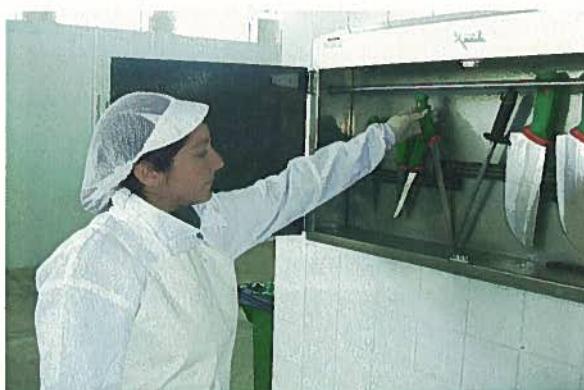
Figura 13.- Cuando utilizamos un esterilizador de cuchillos U.V.A. (ultravioleta) es necesario controlar que no existen restos orgánicos, ya que la acción desinfectante es sólo en la superficie.
