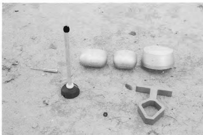
Foto Nº 1: Sondas de prueba para determinar los atrapamientos
