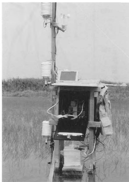
Foto 6: Instalación permanente para la medida de las concentraciones de nitrógeno amoniacal.
