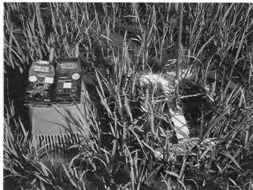
Foto 2: Medición del potencial redox en campo.
