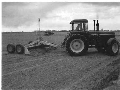
Foto 3. Nivelación de la parcela mediante el uso del láser
