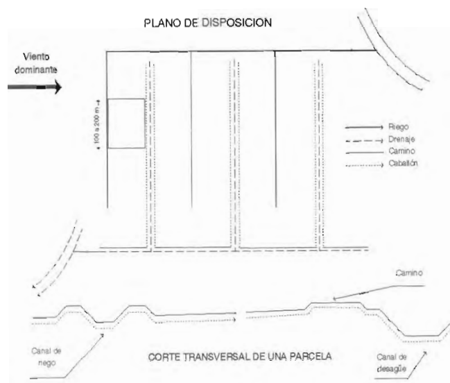
Figura 7. Esquema de la distribución de un arrozal. (Fuente D.D.A. Bouches-du-Rhone)
