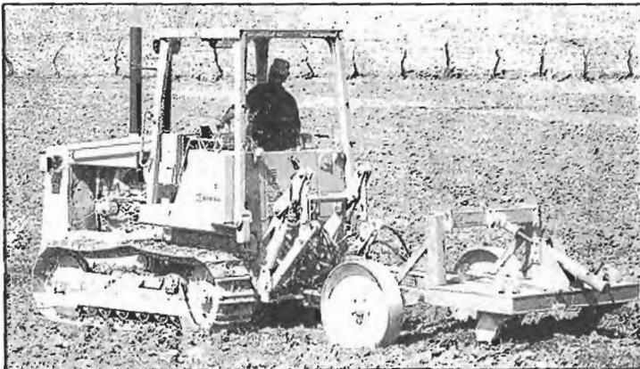
Fig. 333. Subsolador remolcado.
