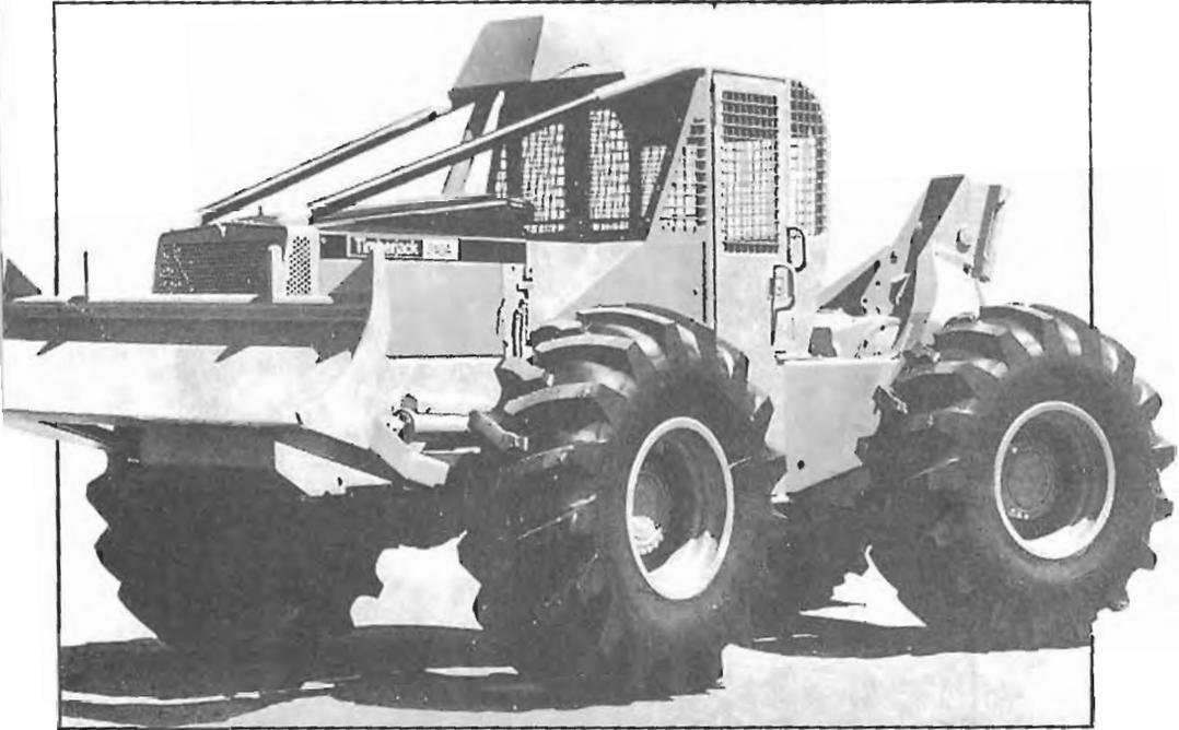
Fig. 488. Skidder TIMBERJACK, mod. 240A (CANADÁ). Características: Motor Diesel de dos tiempos (G.M.), de 4 cilindros, refrigerado por agua, 3,39 l. de cilindrada y 109 H.P. de potencia; transmisión directa con caja de cambios sincronizada de 6 marchas de avance y 1 de retroceso; frenos de disco a la transmisión de accionamiento hidráulico; bastidor articulado y eje delantero basculante; dirección hidrostática mandada por palanca; un cable de 13.600 kg. de tracción.
