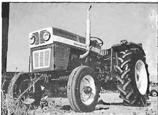
Fig. 325.- Tractor agrícola de ruedas y tracción simple (UNIVERSAL).
