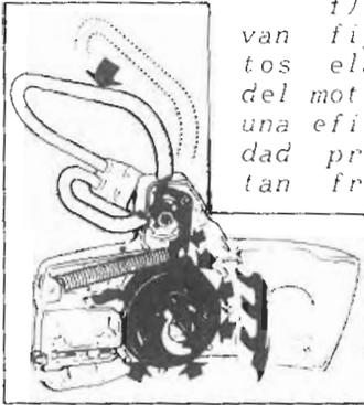
Fig. 436. Detalle del accionamiento del freno de cadena (PARTNER).
