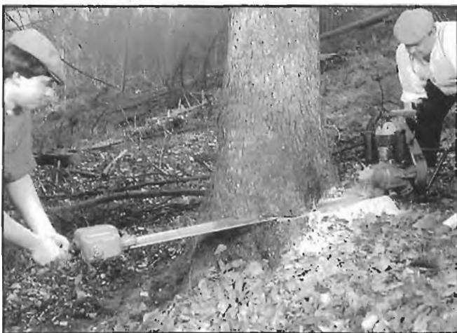
Fig. 18. Primera motosierra Stihl con motor de gasolina.
