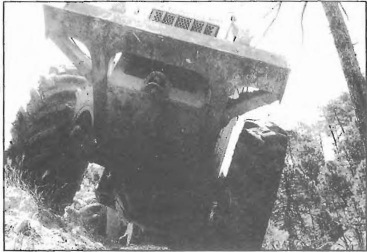
Fig. 482. Los bajos del skidder se protegen con una fuerte coraza.
