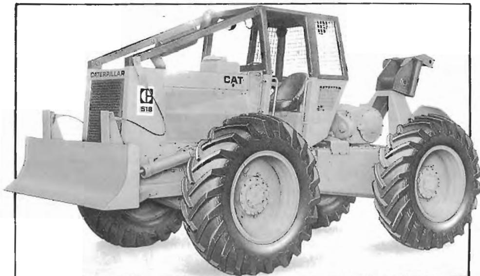
Fig. 487. Skidder CATERPILLAR, mod. 518 (EE.UU.). Características: Motor Diesel turboalimentado de 4 cilindros, refrigerado por agua, 7 l. de cilindrada y 120 H.P. de potencia; transmisión "Power shift", con 3 marchas de avance y 3 de retroceso; frenos de disco al eje motor y ruedas delanteras, con accionamiento hidroneumático; bastidor articulado y oscilante; dirección hidrostática mandada por barra; un cabrestante de 14.700 Kg. de tracción.
