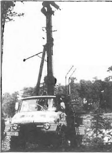
Fig. 505. Estación motriz de un teleférico con bloqueadores, sobre vehículo UNIMOG.
