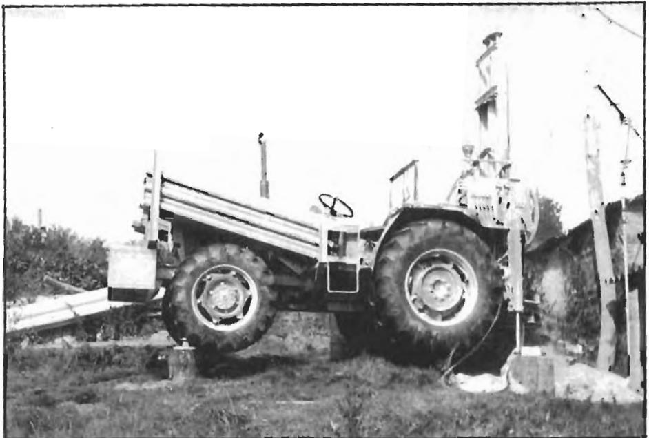
Fig. 592. Martillo perforador pesado y de accionamiento mixto, montado sobre un tractor.
