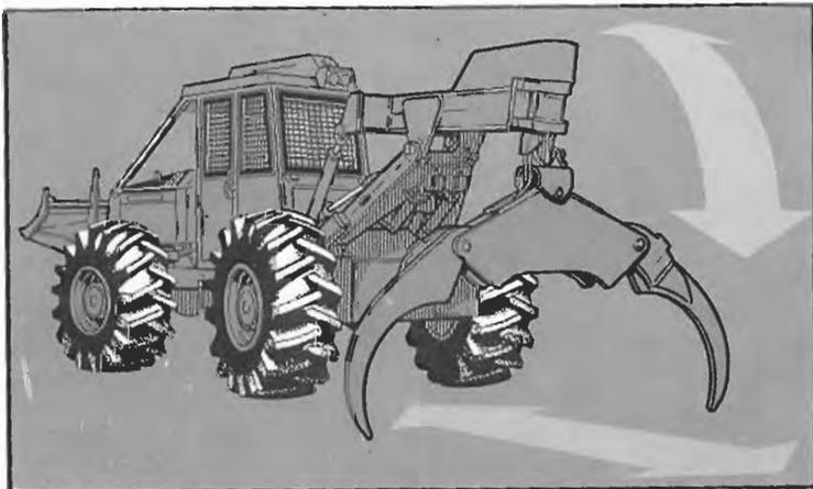
Fig. 478. Skidder con grapa para troncos (TIMBERJACK).
