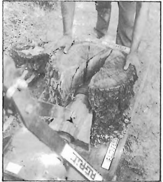
Fig. 523. Detalle del trabajo de la rajadora mecánica (AGRIC).
