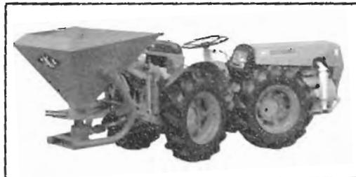
Fig. 350. Abonadora centrífuga (ZAGA) sobre tractor articulado (AGRIA).
