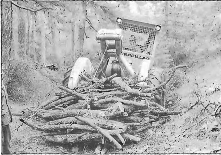
Fig. 515. El extremo de los chokers, opuesto al enganchado en el escudo, se engancha en las piezas del cable tractor; al tensar éste quedará la carga suspendida y equilibrada.
