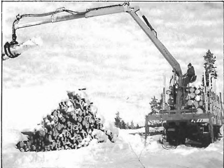
Fig. 532. Grúa de brazos telescópicos montada en la parte trasera de la plataforma de un camión (FISKARS).
