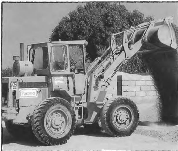
Fig. 560. Pala de ruedas (CAT). 1.- Corazas del motor. 2.- gas. Cilindros de elevación. 3.- Cabina de seguridad. 4.- Brazos. 5.- Cucharón.
