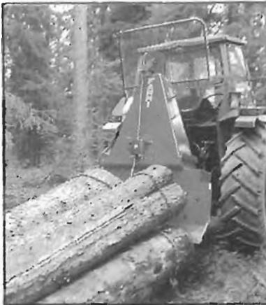
Fig. 500. Cabrestante sobre tractor, provisto de arco, escudo y rejilla protectora contra rotura del cable (FARM).
