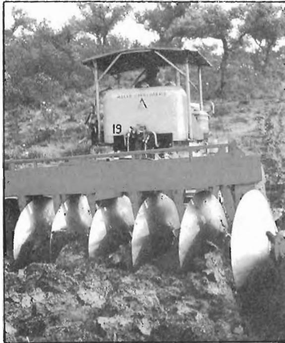
Fig. 348. Grada pesada para trabajos forestales (HALCON).
