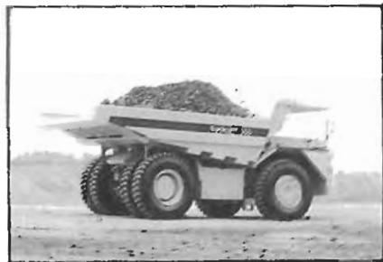
Fig. 557. Dumper pesado de bastidor rígido, nas de 600 H.P. de potencia y 50.000 Kg. de carga (КОСКОМ).
