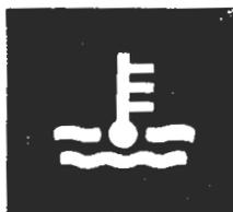
Fig. 75. Lámpara testigo de temperatura del agua.
