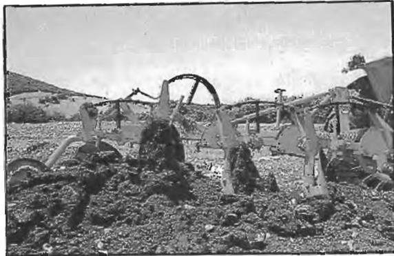
Fig. 342. Arado multidisco con sistema de basculamiento.
