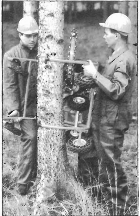
Fig. 390.- Colocación de la sierra trepadora sobre un árbol (SACHS).
