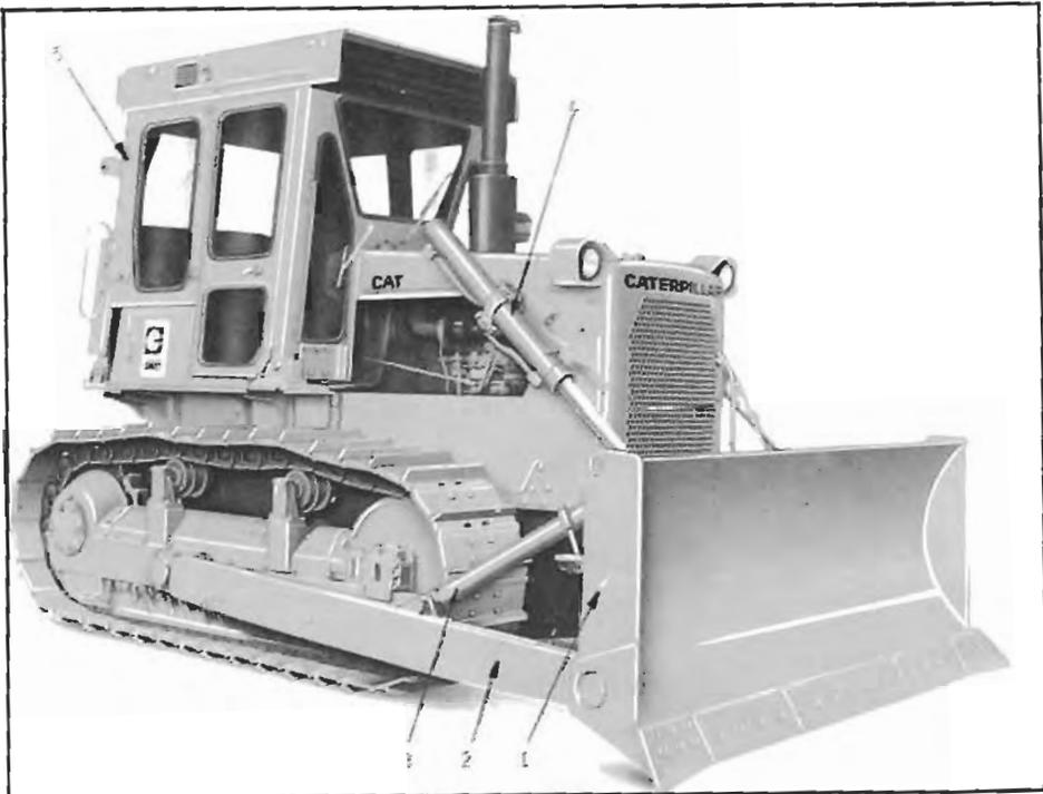
Fig. 542. Bulldozer sobre tractor de orugas (CATERPILLAR). 1.- Hoja. 2.- Bastidor. 3.- Brazo de inclinación. 4.- Cilindro Hidráulico. 5.- Cabina o estructura de seguridad.
