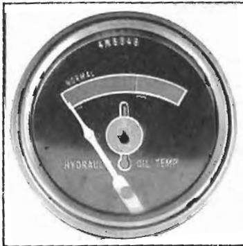
Fig. 293. Termómetro de control de temperatura del sistema hidráulico.
