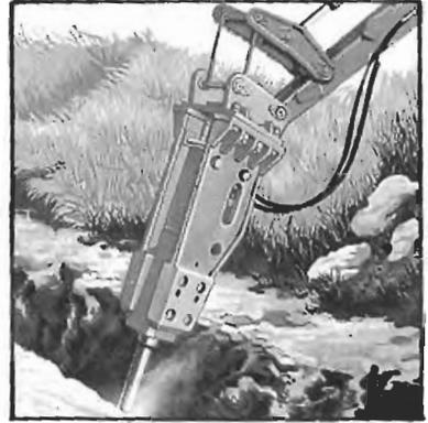
Fig. 591. Martillo rompedor hidráulico, montado sobre retroexcavadora.
