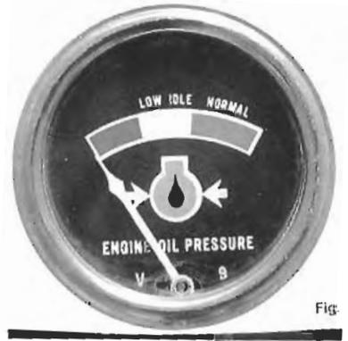
Fig. 60. Manómetro de aceite del motor.
