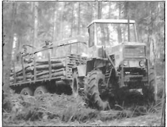
Fig. 501. Tractor 4x4, provisto de grúa hidráulica sobre el propio tractor y remolque forestal (MB trac)
