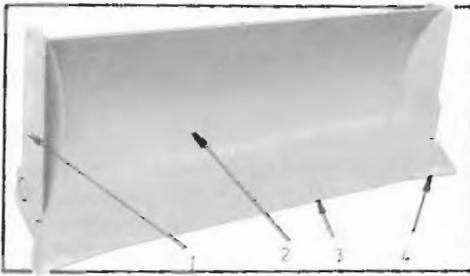
Fig. 543. Partes de la hoja bulldozer. 1.- Refuerzo lateral. 2.- Vertedera. 3.- Cuchilla. 4.- Punta de extremo o "Cantonera".
