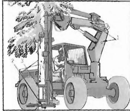
Fig. 446. Taladora sobre tractor de neumáticos. 1.- Pluma. 2.- Cizalla. 3. Grapa.
