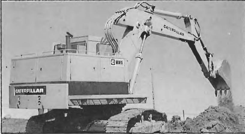
Fig. 361. Retroexcavadora pesada con nas de 300 H.P. de potencia y unas 50 Tm. de peso (CATERPILLAR).
