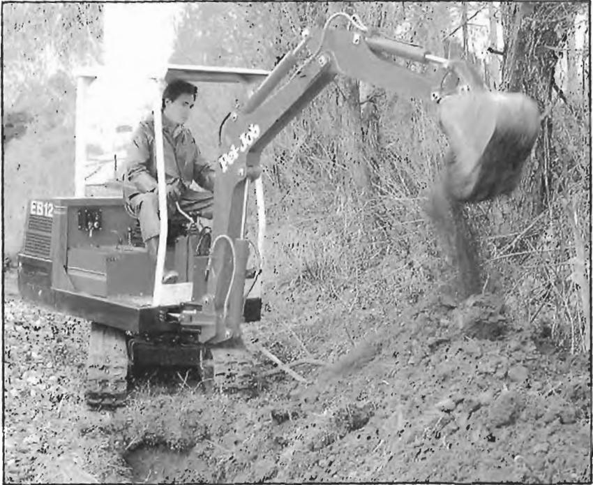
Fig. 360. Retroexcavadora ligera con 13,7 H.P. de potencia y 1.245 Kg. de peso. (PEL-JOB).
