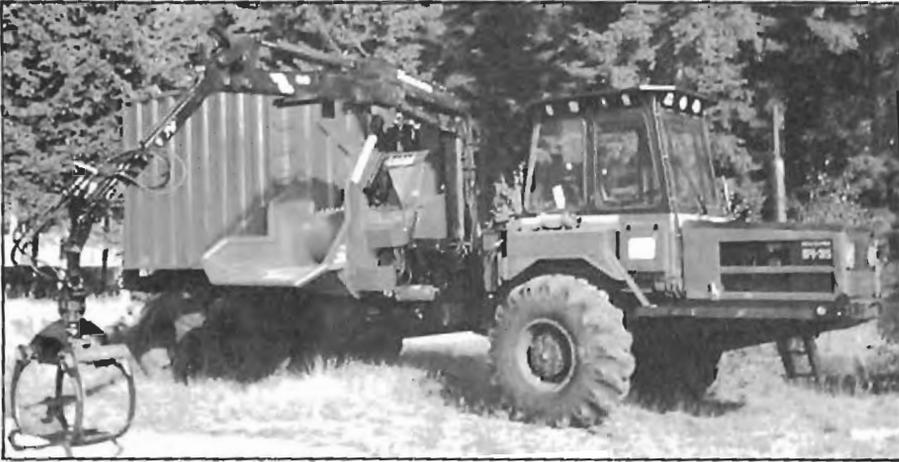
Fig. 521. Astilladora y tolva (ERJO) sobre autocargador (KOCKUM).
