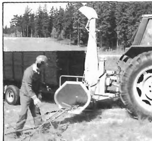
Fig. 519. Astilladora alimentada a mano, durante su trabajo. Obsérvese que el tractor que la acciona lleva remolque para recibir directamente las astillas (ERJO).
