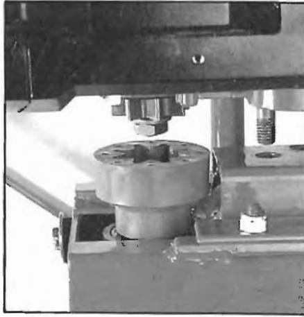
Fig. 510. Detalle del acoplamiento del piñón de arrastre de la motosierra a la transmisión del cabrestante (KBF).
