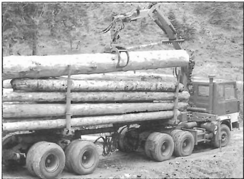
Fig. 526. Camión tipo "tractora", con remolque de chasis telescópico para el transporte de troncos y grúa hidráulica (FISKARS).
