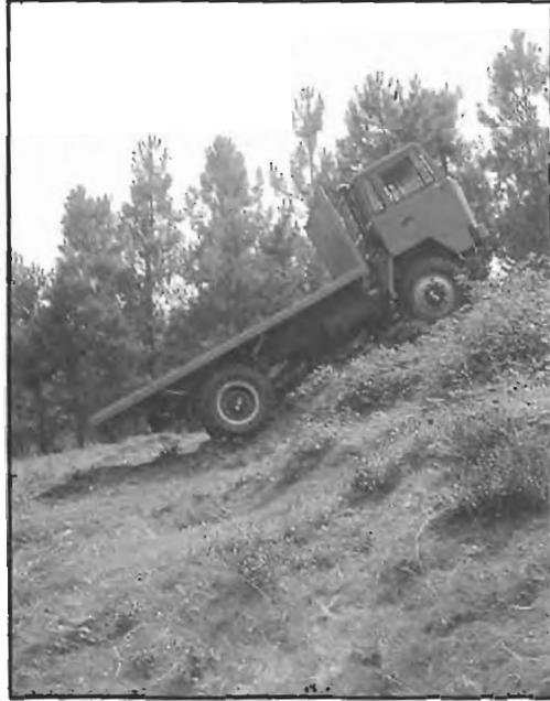
Fig. 24. Canión todo terreno I.P.V. de 180 H.P., fabricado por MAFSA en Puente Nuevo (Lugo).
