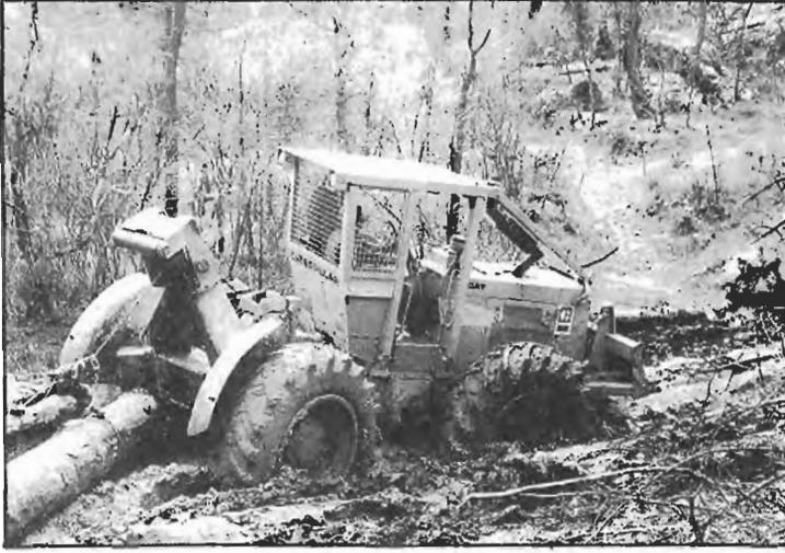
Fig. 470. Las condiciones desfavorables del terreno por el que han de circular los tractores forestales, obligan a que éstos tengan todas las ruedas motrices.
