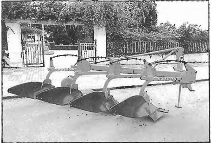
Fig. 337.- Arado polisueco, fijo, de vertedera; equipado con sistema de basculamiento de los cuerpos por medio de ballestas, para evitar enganches (HALCON).
